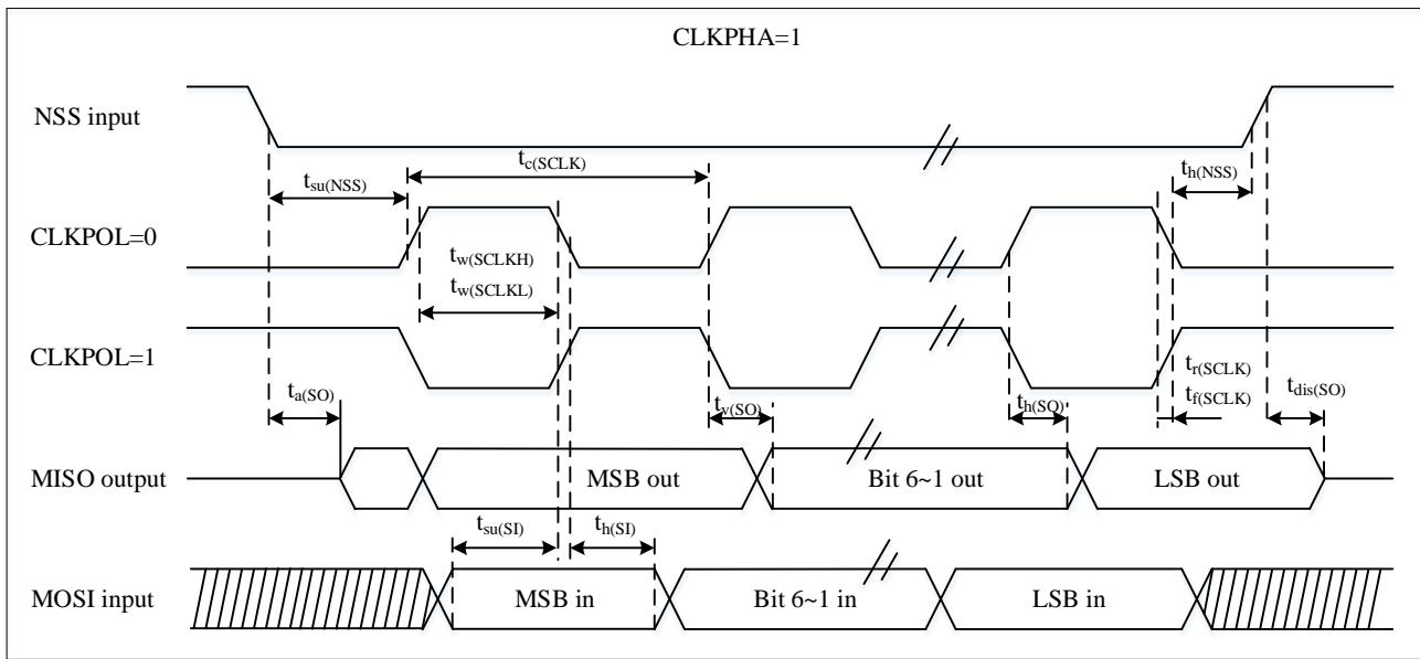
1. 测量点设置于CMOS电平：0.3VDD和0.7VDD。
