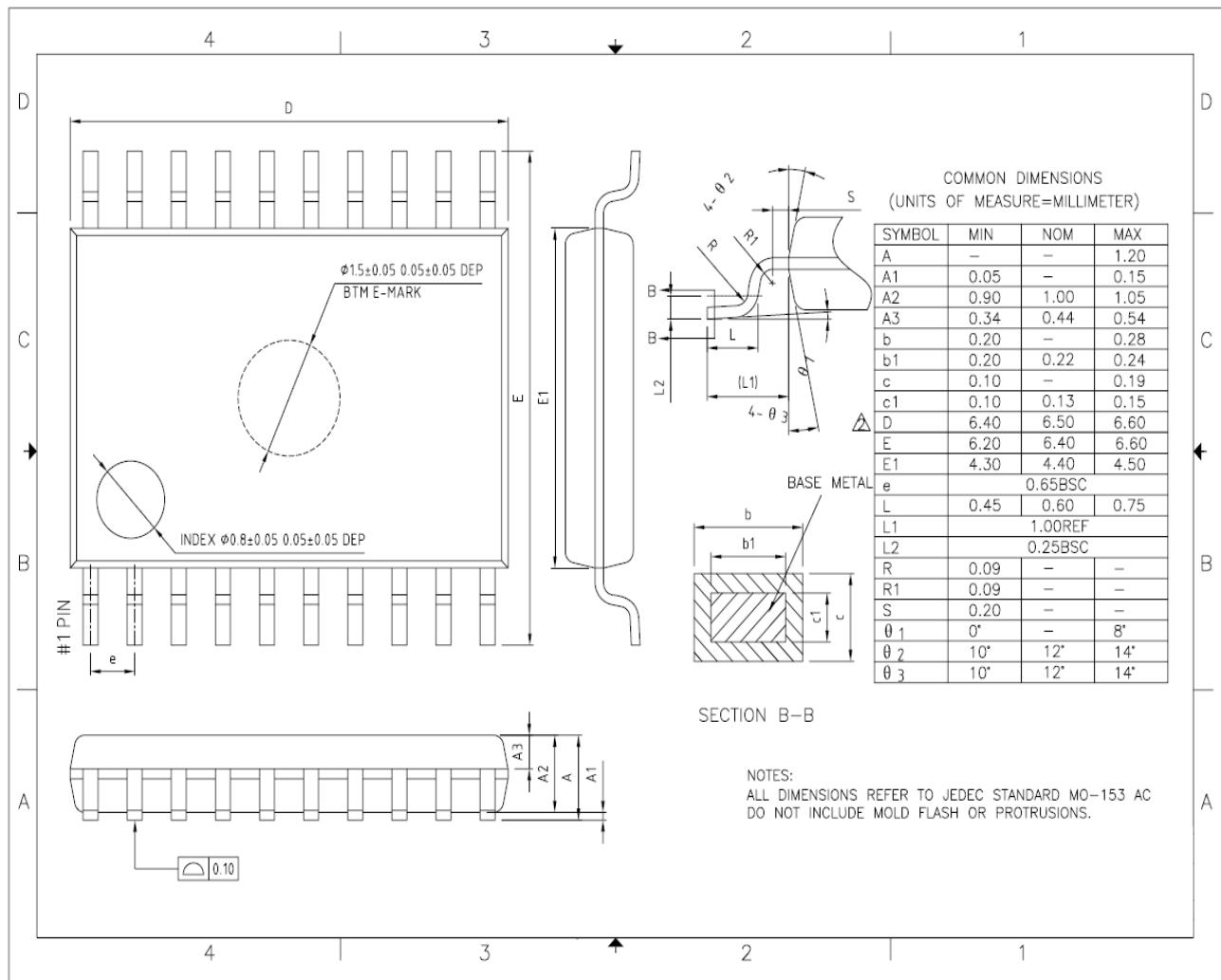
图 5-14 TSSOP20封装焊盘建议<sup>(1)</sup>
