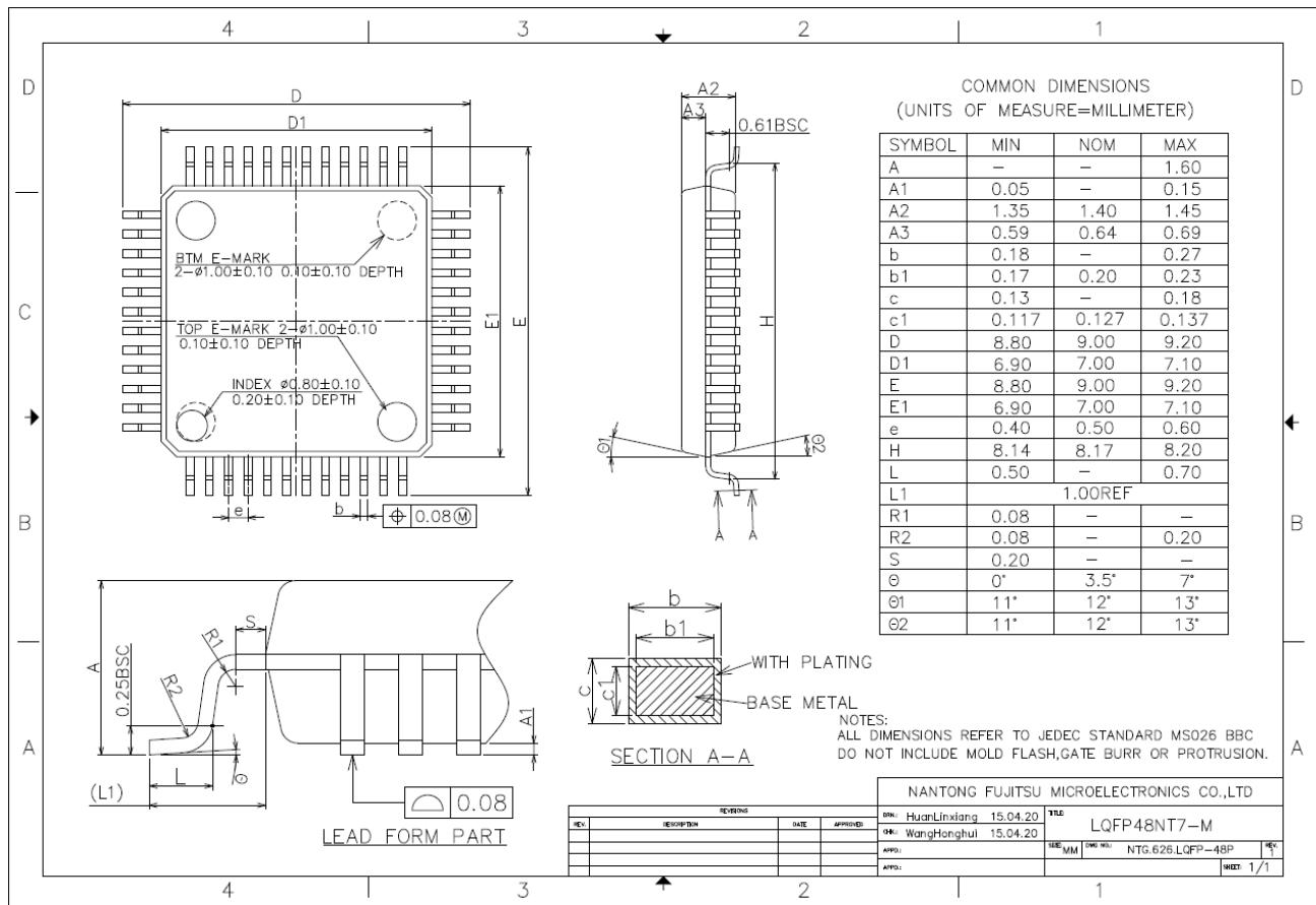
图 5-4 LQFP48封装焊盘建议<sup>(1)</sup>
