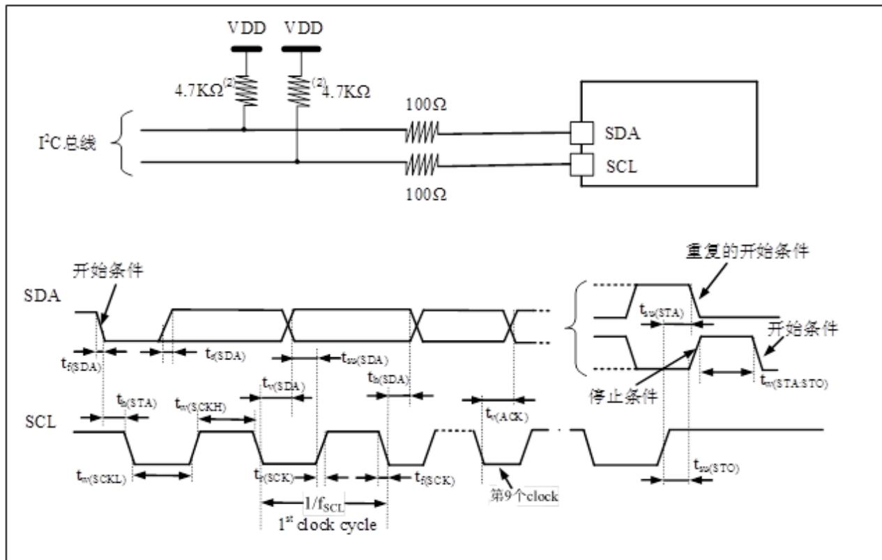
1. 测量点设置于CMOS电平：0.3V<sub>DD</sub>和0.7V<sub>DD</sub>。
