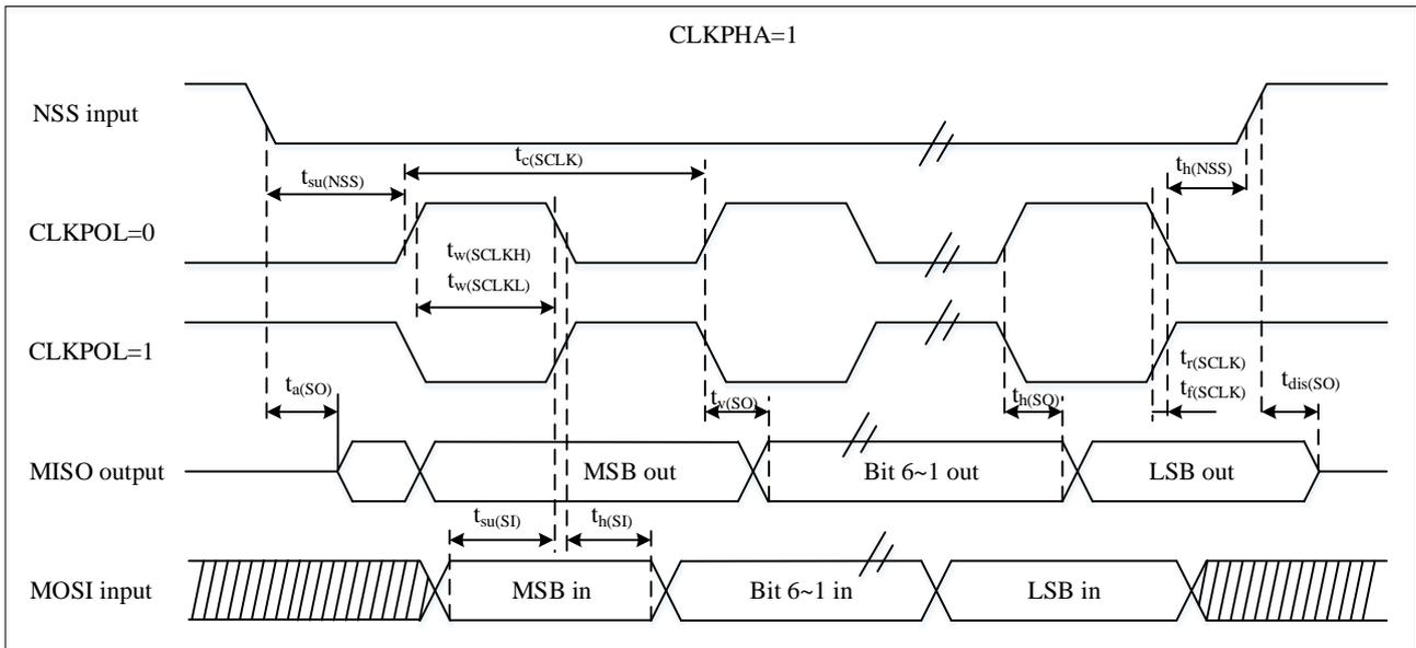
1. 测量点设置于CMOS电平：0.3VDD和0.7VDD。
