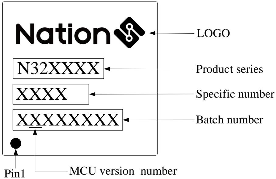
图 5-16 QFN32(4mm x 4mm)丝印说明图
