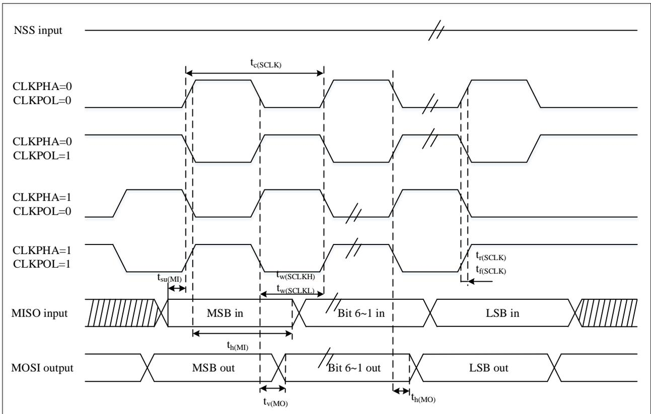
1. 测量点设置于CMOS电平：0.3VDD和0.7VDD。
