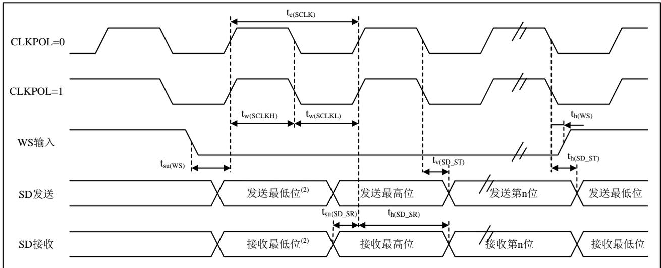
1. 测量点设置于CMOS电平：0.3V<sub>DD</sub>和0.7V<sub>DD</sub>。
