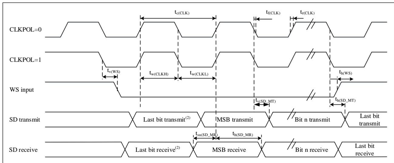
1. 测量点设置于CMOS电平：0.3V<sub>DD</sub>和0.7V<sub>DD</sub>。
