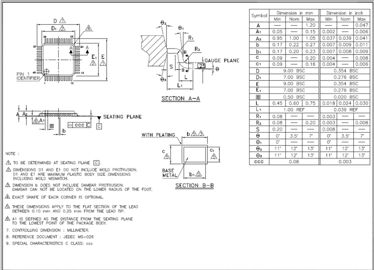
图 5-4 TQFP48封装焊盘建议<sup>(1)</sup>
