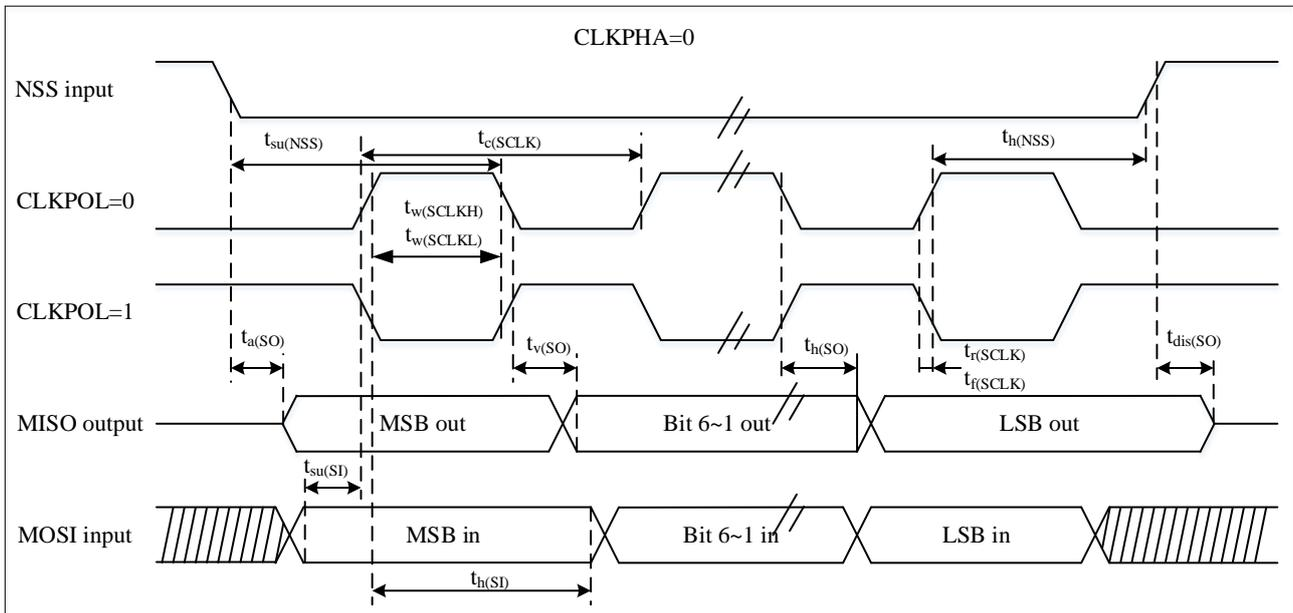
图 4-13 SPI时序图 – 从模式和CPHA=1<sup>(1)</sup>
