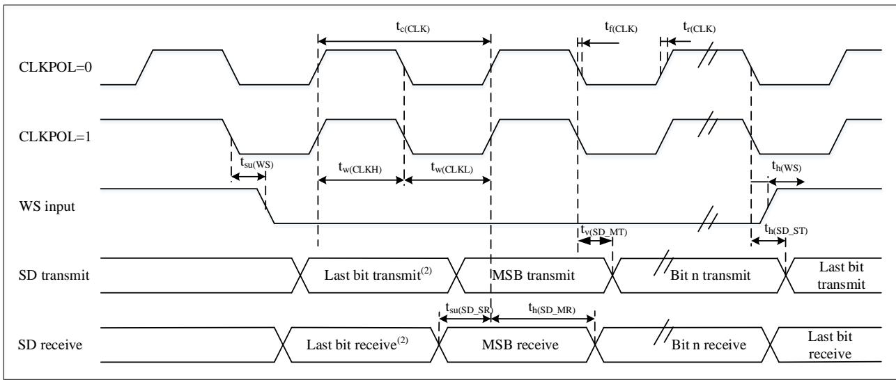
1. 测量点设置于0.3V<sub>DD</sub>和0.7V<sub>DD</sub>。
