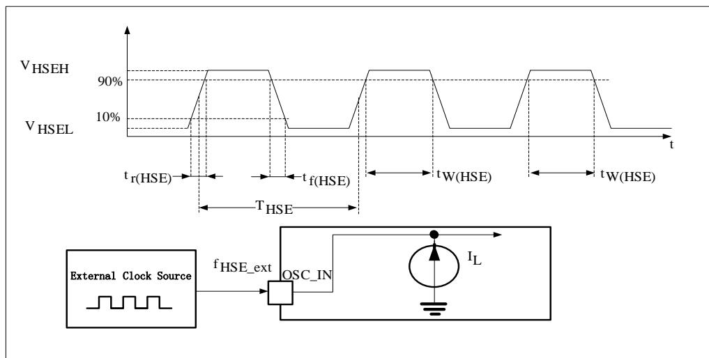
图 4-6 外部低速时钟源的交流时序图
