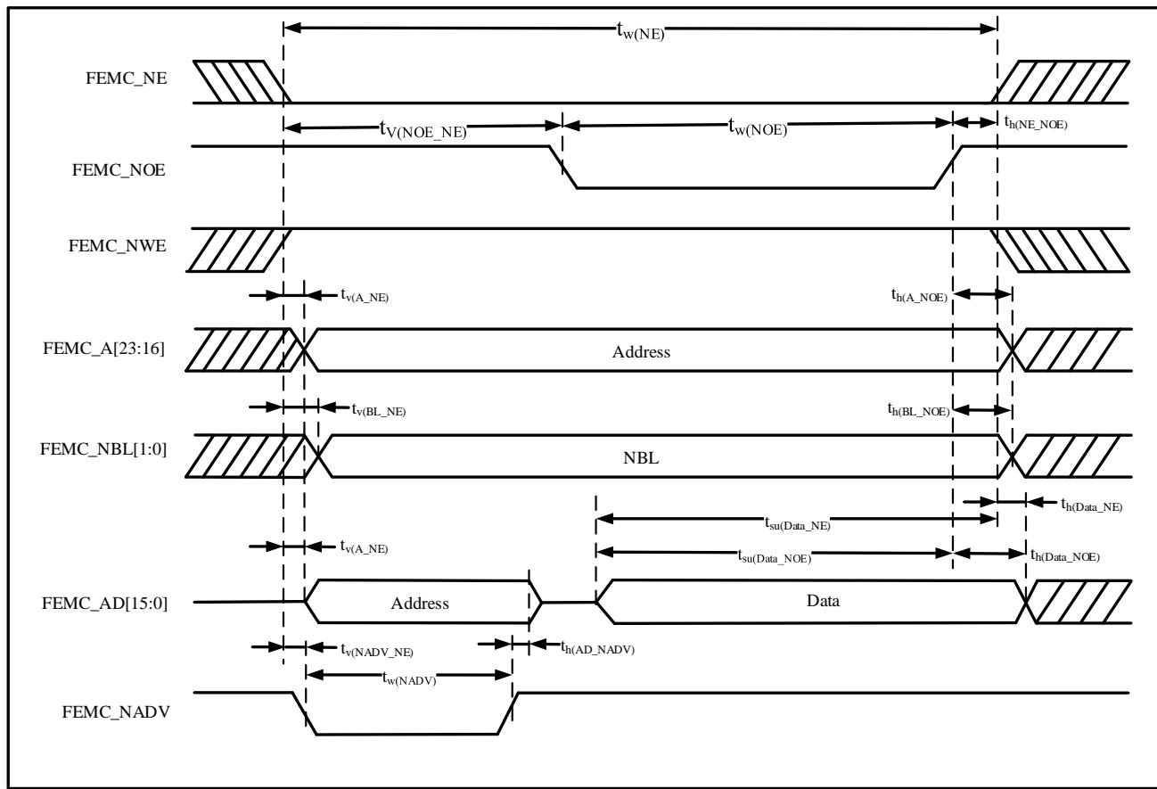
表 4-46 异步总线复用的PSRAM/NOR读操作时序<sup>(1)(2)</sup>
