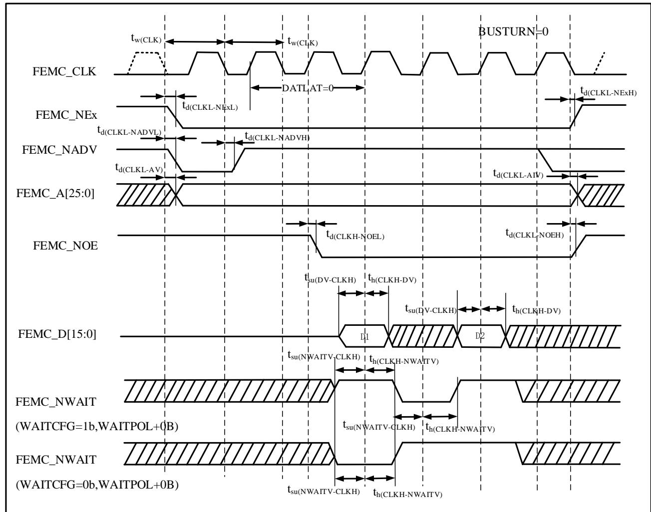
表 4-48 同步非总线复用NOR/PSRAM读时序<sup>(1)(2)</sup>
