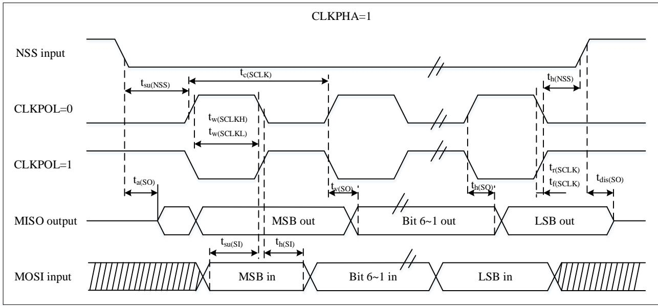
1. 测量点设置于0.3V<sub>DD</sub>和0.7V<sub>DD</sub>。
