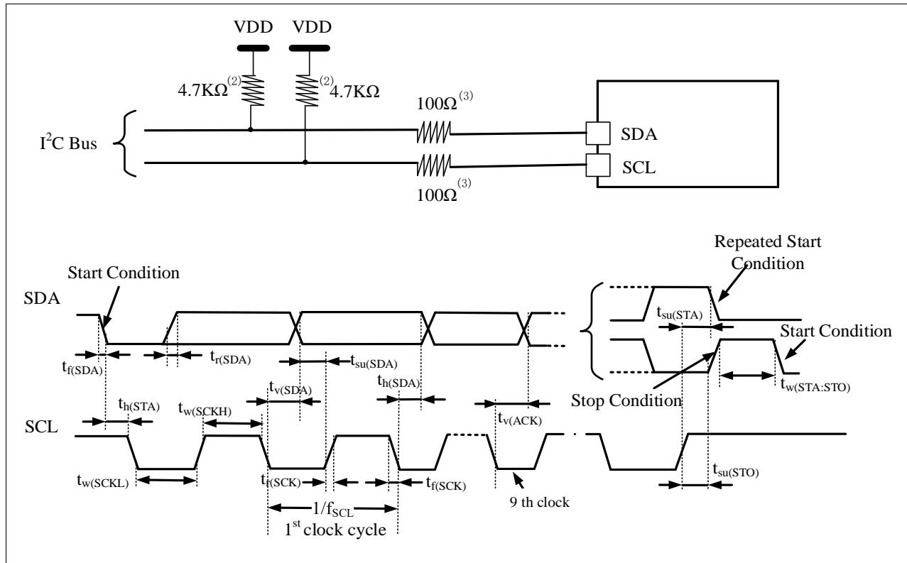
1. 测量点设置于CMOS电平：0.3V<sub>DD</sub>和0.7V<sub>DD</sub>。
