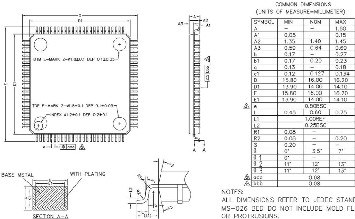
图 5-4 LQFP100 封装焊盘建议<sup>(1)</sup>
