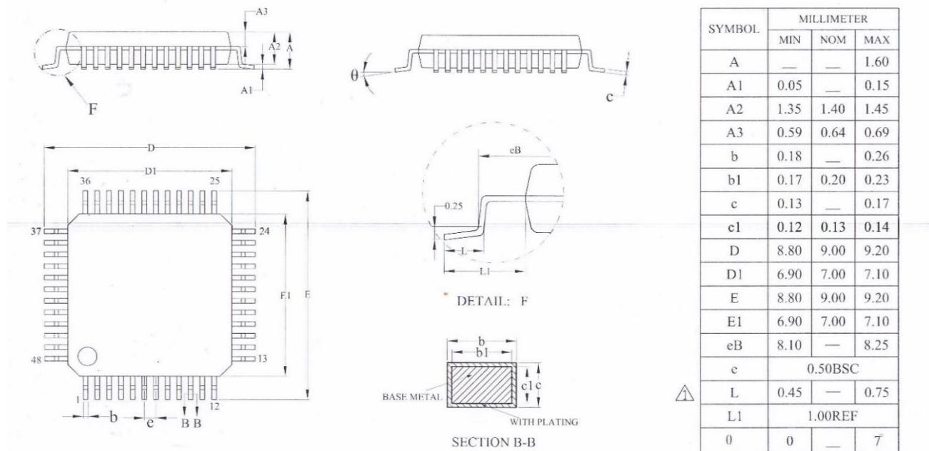
图 5-4 LQFP48 封装焊盘建议<sup>(1)</sup>
