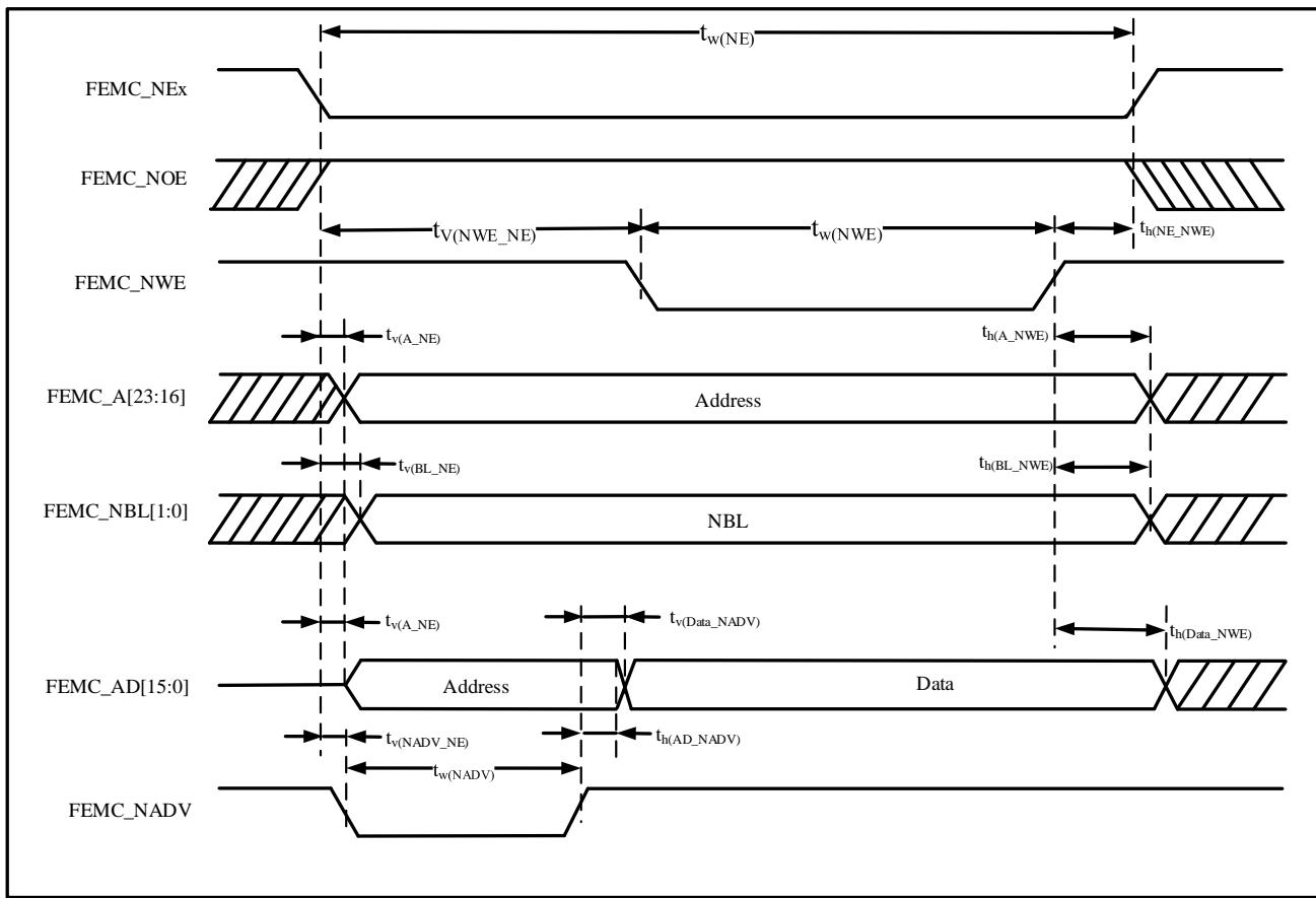
表 4-52 异步总线复用的PSRAM/NOR写操作时序<sup>(1)(2)</sup>
