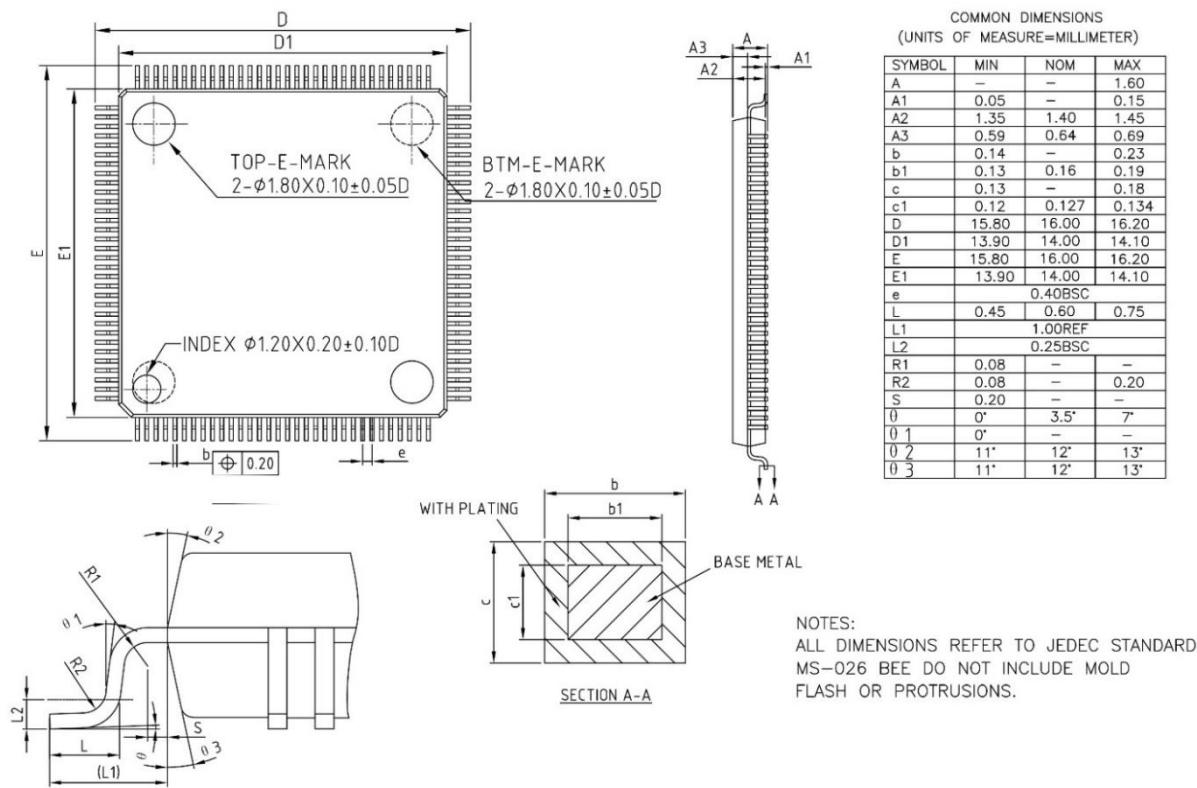
图 5-12 LQFP128 封装焊盘建议<sup>(1)</sup>
