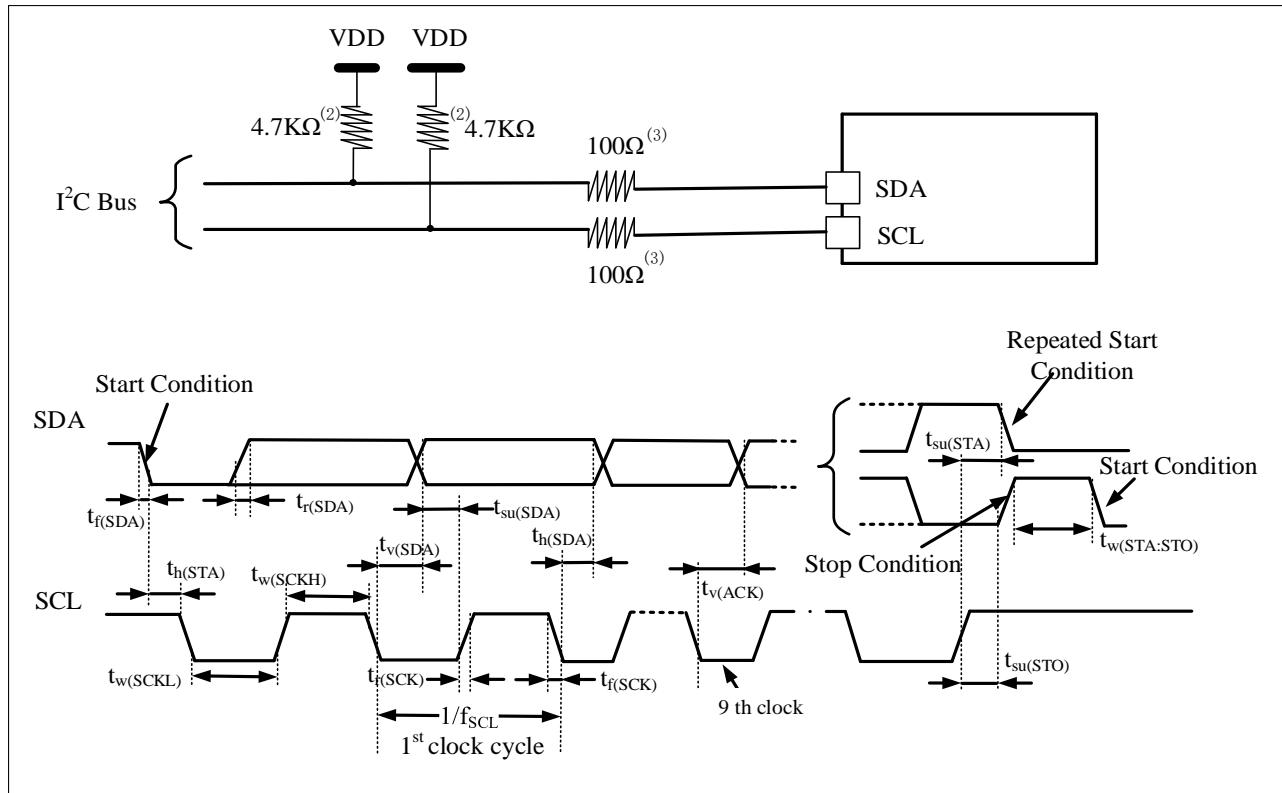
1. 测量点设置于CMOS电平：0.3V<sub>DD</sub>和0.7V<sub>DD</sub>。
