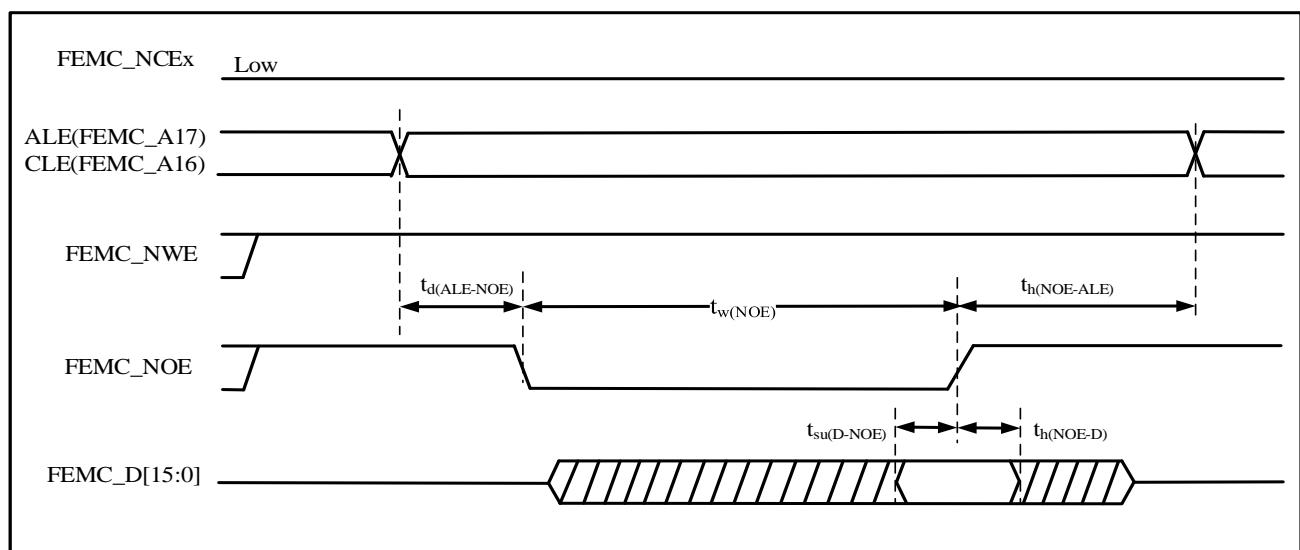
图 4-32 NAND控制器在通用存储空间的写操作波形
