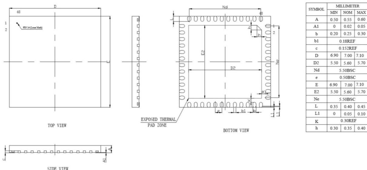
图 5-2 UQFN48 封装焊盘建议<sup>(1)</sup>
