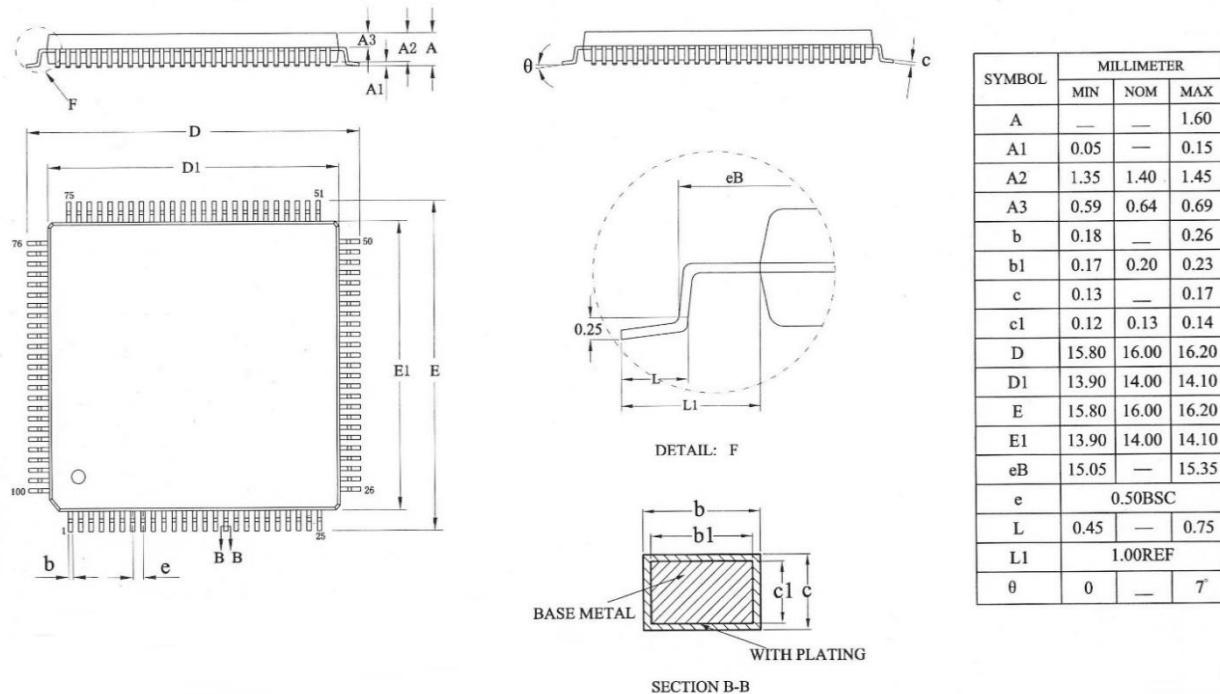
图 5-10 LQFP100 封装焊盘建议<sup>(1)</sup>
