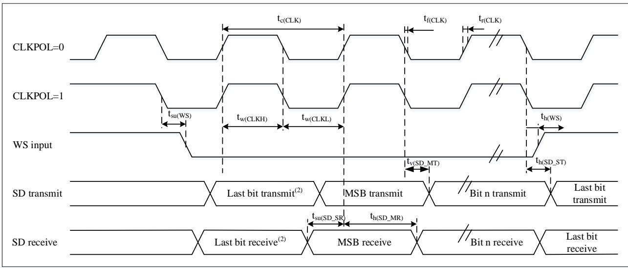
1. 测量点设置于0.3V<sub>DD</sub>和0.7V<sub>DD</sub>。
