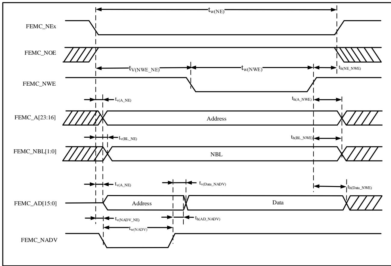
表 4-49 异步总线复用的PSRAM/NOR写操作时序<sup>(1)(2)</sup>
