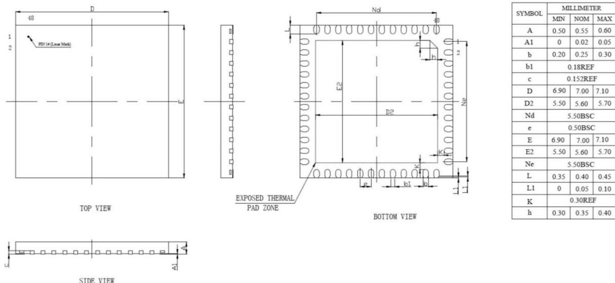
图 5-6 UQFN48/UQFN48-1 封装焊盘建议<sup>(1)</sup>
