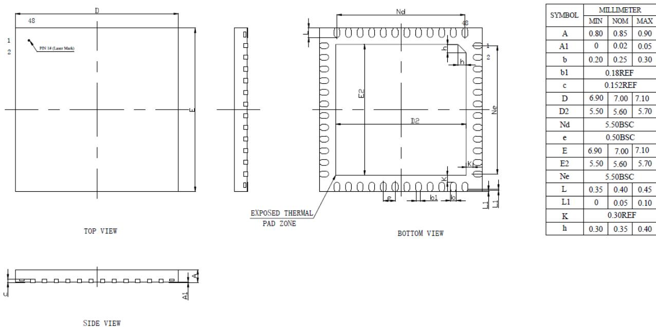
图 5-4 QFN48 封装焊盘建议<sup>(1)</sup>
