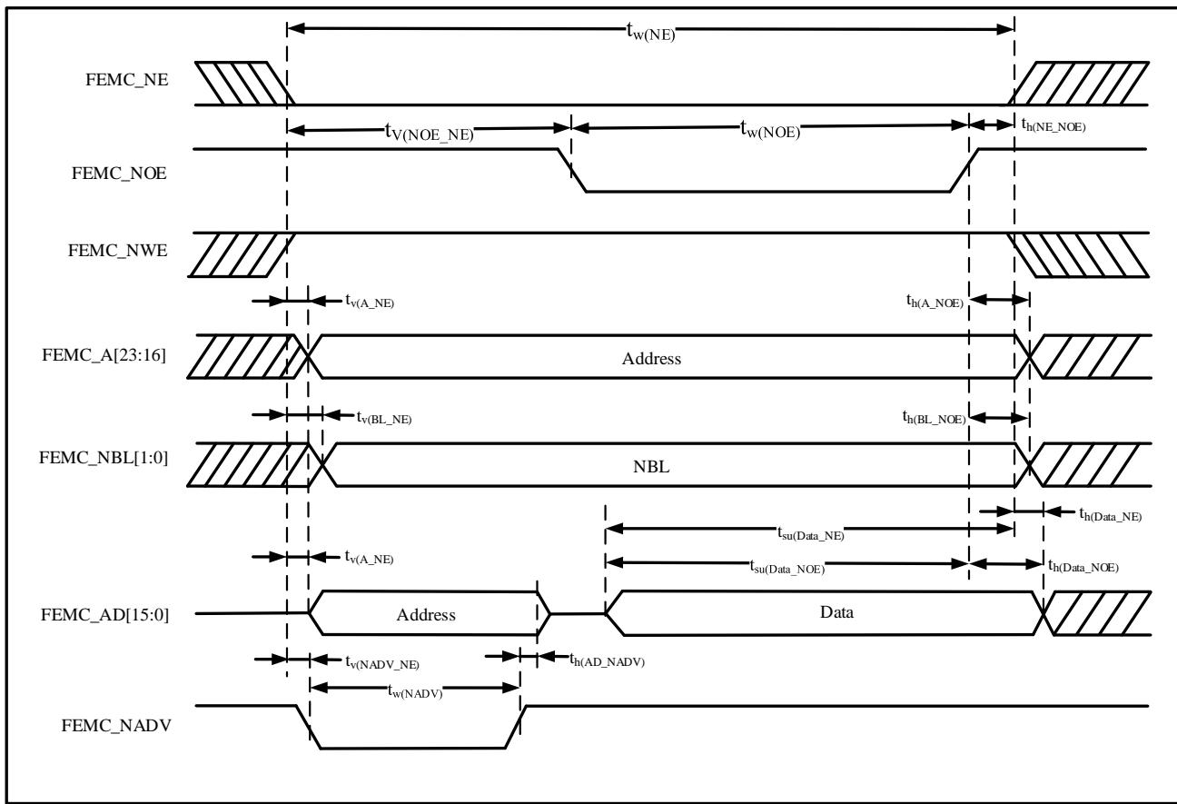
表 4-48 异步总线复用的PSRAM/NOR读操作时序<sup>(1)(2)</sup>
