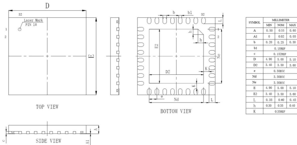
图 5-2 UQFN32 封装焊盘建议<sup>(1)</sup>
