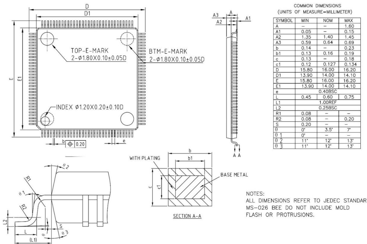
图 5-16 LQFP128 封装焊盘建议<sup>(1)</sup>
