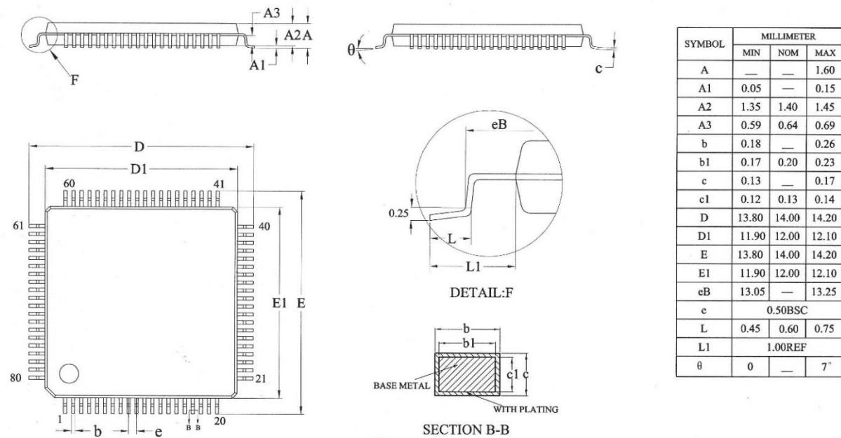
图 5-12 LQFP80 封装焊盘建议<sup>(1)</sup>
