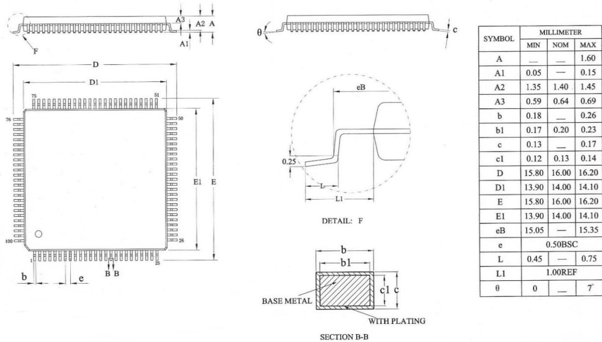
图 5-14 LQFP100 封装焊盘建议<sup>(1)</sup>
