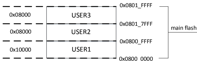
图 4-1 Flash 主存储区区域划分关系示例
