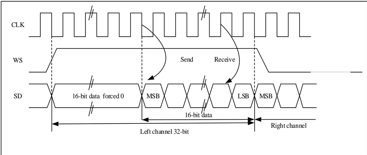
如果 16 位数据需要打包进 32 位数据帧格式，每帧数据传输时，CPU 仅需要读或写 SPI\_DAT 寄存器一次。扩展到 32 位数据的高 16 位被硬件设置为 0x0000，如果用户发送或接收 16 位数据 0x89C1（扩展到 32 位数是 0x000089C1）。发送过程中，高 16 位半字（0x0000）需要先写到 SPI\_DAT 寄存器；一旦有效数据开始发送，下一个 TE 事件将产生。接收数据过程中，一旦设备接收到有效数据，RNE 事件将发生。这样，在 2 次读和写之间 CPU 将有更多时间，可以防止上溢或下溢的情况发生。
