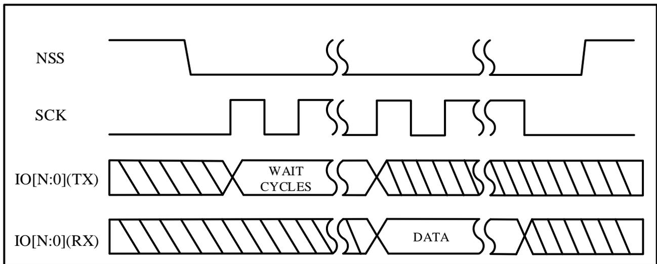
QSPI\_ENH\_CTRL0.ADDR\_LEN[3:0] 配置为 0，QSPI\_ENH\_CTRL0.INST\_L[1:0] 配置为 0，QSPI\_ENH\_CTRL0.WAIT\_CYCLES[4:0]配置 wait cycles。QSPI\_CTRL0.SPI\_FRF[1:0]配置为 0x02（四线模式）时，N=3；QSPI\_CTRL0.SPI\_FRF[1:0]配置为 0x01（双线模式）时，N=1。
