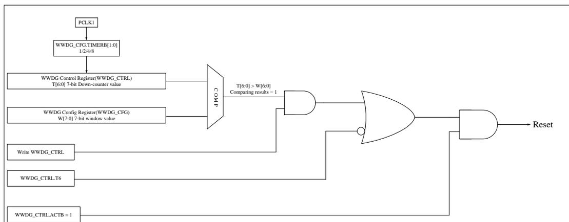
设置 WWDG\_CTRL.ACTB 位以启用看门狗, 此后, WWDG 将保持打开状态, 直到发生复位。7 位递减计数器独立运行, 无论 WWDG 是否使能, 计数器都会持续递减计数。因此, 使能看门狗前, 需要将 WWDG\_CTRL.T[6] 位设置为 1, 以防止在启用后立即复位。由时钟 APB1 和 WWDG\_CFG.TIMERB[1:0] 设置的预分频器值决定了计数器的递减速度。WWDG\_CFG.W[6:0] 位设置窗口的上限。
