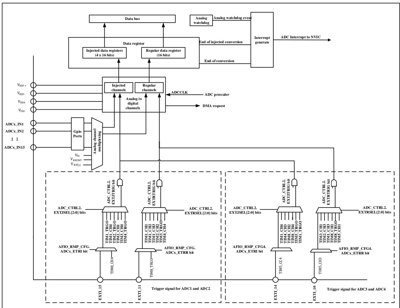
注意：ADC1 和 ADC2，ADC3 和 ADC4 的规则转换和注入转换触发参考具体的寄存器定义。
