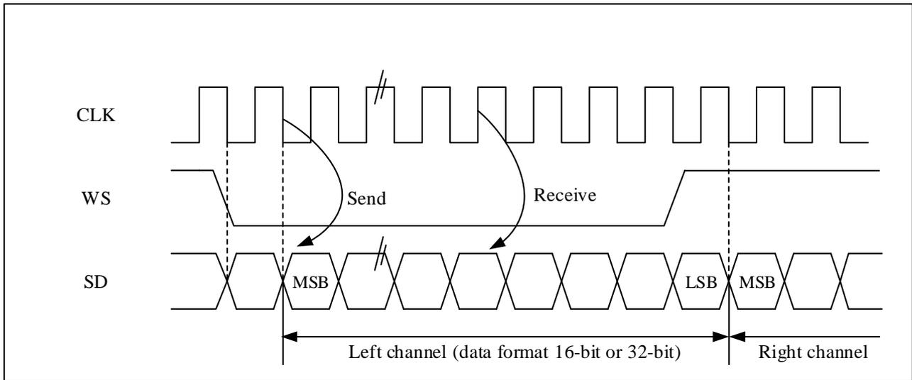
图 21-15 I<sup>2</sup>S 飞利浦协议标准波形 (24 位帧, CLKPOL = 0)
