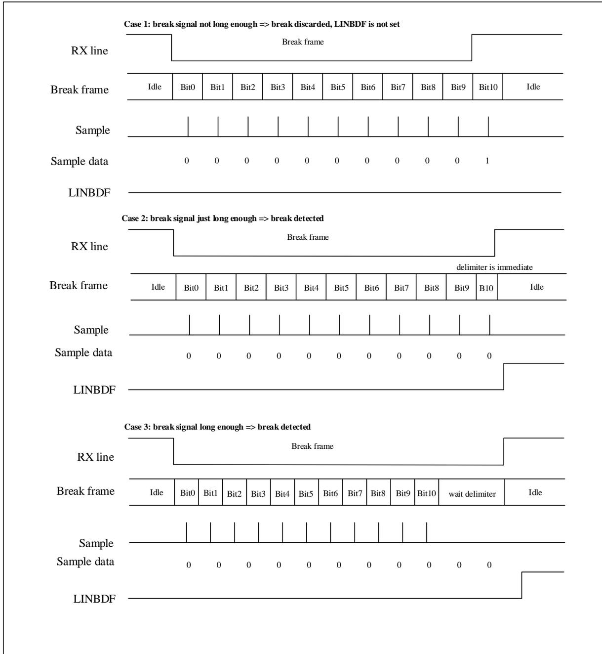
图 23-22 LIN 模式下的断开检测与帧错误的检测
