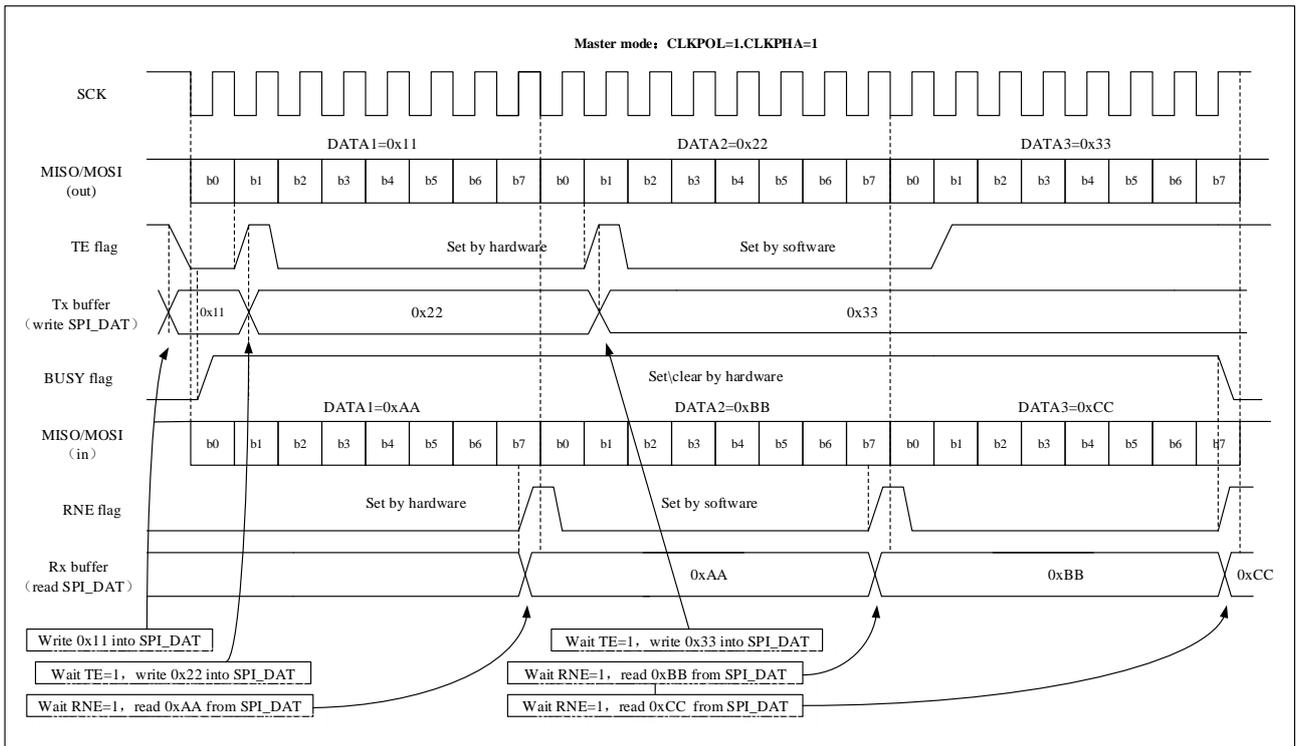
■ 主机双线单向仅发送模式 (SPI\_CTRL1.MSEL = 1, SPI\_CTRL1.BIDIRMODE = 0, SPI\_CTRL1.RONLY = 0)
