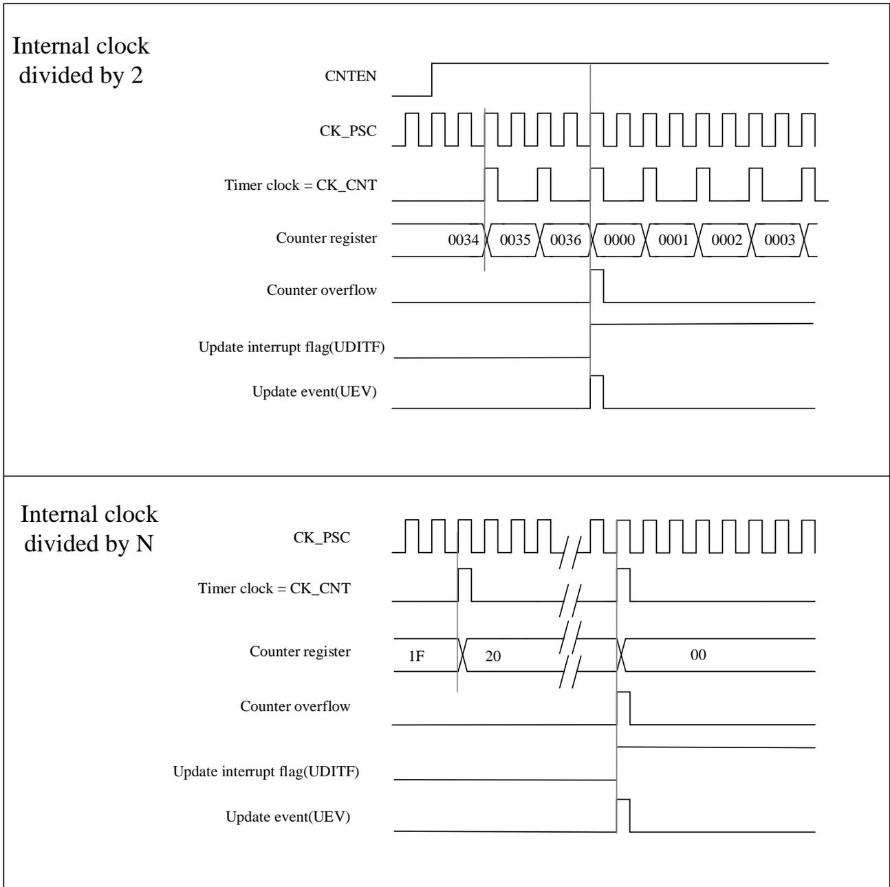
图 13-4 ARPEN=0/1 时向上计数、更新事件的时序图
