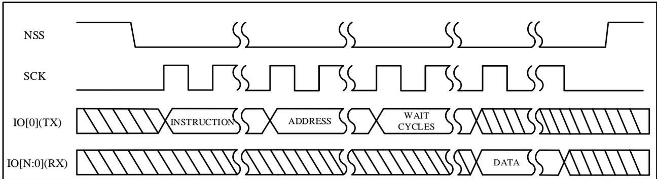
四线模式下  $N=3$ ，每个读取命令数据将以 `QSPI_CTRL0.SPI_FRF[1:0]` 配置的格式传输。配置为 `0x2` 为四线模式。
