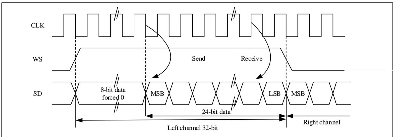
如果 24 位数据需要打包成 32 位数据帧格式，每帧数据传输时，CPU 需要读或写 SPI\_DAT 寄存器 2 次。例如，用户发送 24 位数据 0x95AA66，CPU 将先写 0xXX95（仅低 8 位数据有效，高 8 位数据没有意义，可以是任何值）进 SPI\_DAT 寄存器，然后再写 0xAA66 进 SPI\_DAT 寄存器。如果用户接收 24 位数据 0x95AA66，CPU 将先读 SPI\_DAT 寄存器得到 0x0095（仅低 8 位数据有效，高 8 位总是为 0），然后再读 SPI\_DAT 寄存器得到 0xAA66。
