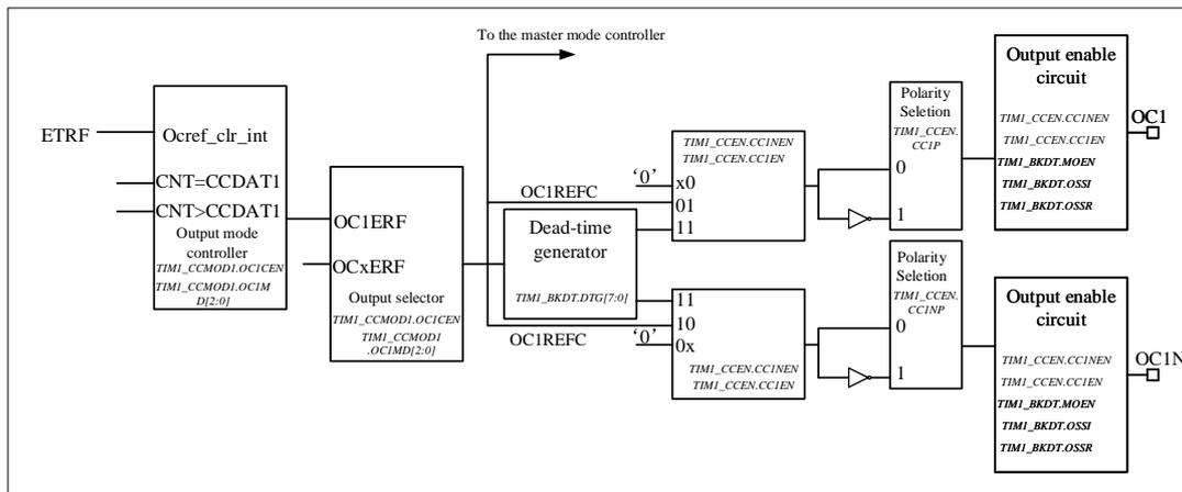
图 11-19 通道 x 的输出部分 (x=4)
