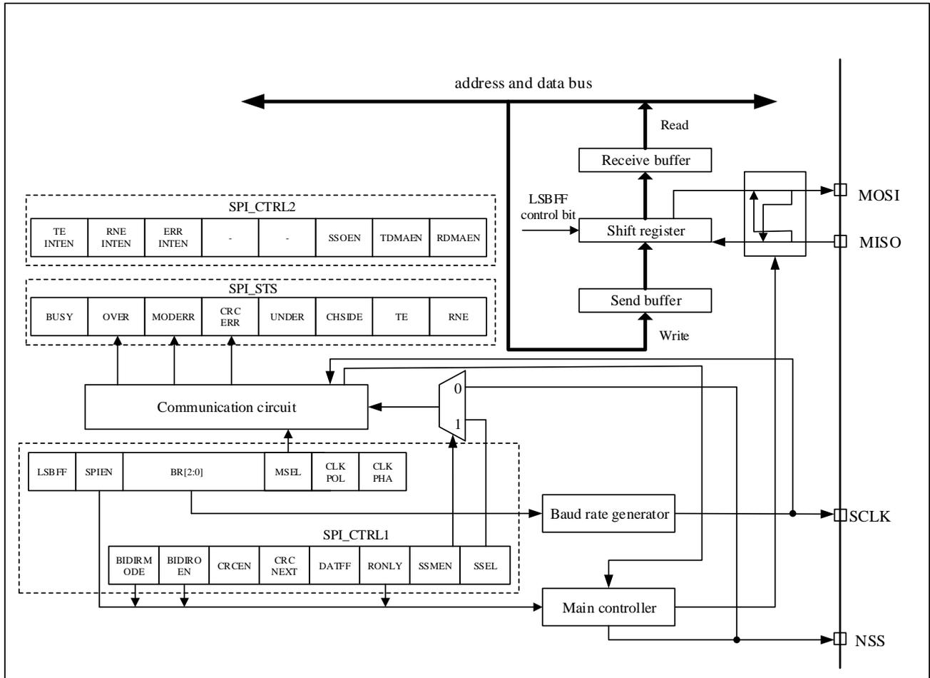
为了连接外部设备，SPI 接口有 4 个引脚与外设器件连接，具体如下：
