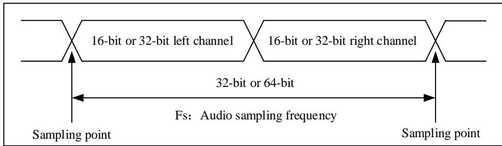
通过设置 SPI\_I2SPREDIV.ODD\_EVEN 位和 SPI\_I2SPREDIV.LDIV 位，可以设置音频的采样信号频率。音频的采样频率可以是 96kHz、48kHz、44.1kHz、32kHz、22.05kHz、16kHz、11.025kHz 或者 8kHz（或任何此范围内的数值）。参照以下公式设置线性分频器：
