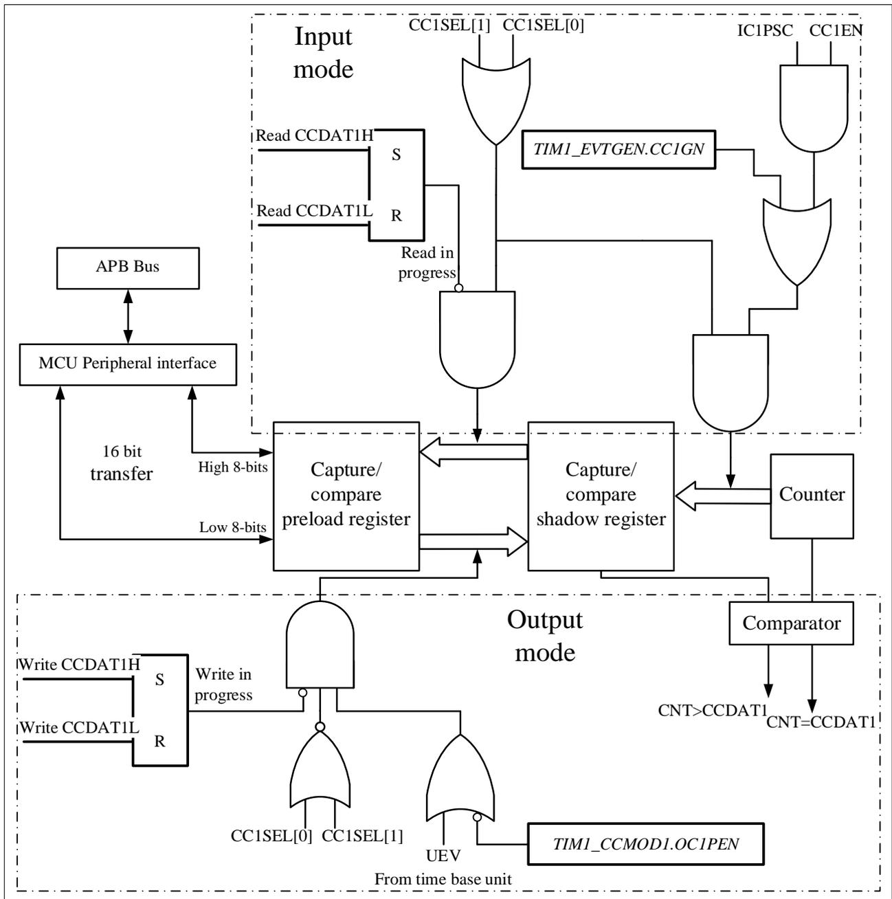
图 11-18 通道 x 的输出部分 (x=1,2,3; 以通道 1 为例子)
