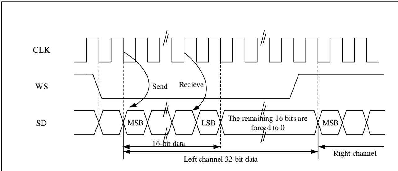
如果 16 位数据需要打包进 32 位数据帧格式，每帧数据传输时，CPU 仅需要读或写 SPI\_DAT 寄存器一次。用于扩展到 32 位的低 16 位数据总是设置为 0x0000。例如，如果用户发送或接收 16 位的数据 0x89C1（扩展到 32 位数据是 0x89C10000）。数据发送过程中，高 16 位半字（0x89C1）需要写进 SPI\_DAT 寄存器；直到 SPI\_STS.TE 位置 1，用户可以写入新的数据。如果用户使能相应的中断，则中断产生。发送由硬件执行，即使最后 16 位（0x0000）没有发送，硬件将设置 SPI\_STS.TE 位为 1，且产生相应的中断。接收数据过程，每次设备收到高 16 位半字（0x89C1）后，SPI\_STS.RNE 标志位将置 1。如果用户使能相应的中断，则中断产生。这样，在 2 次读和写之间 CPU 有更多时间，且可以防止上溢或下溢的情况发生。
