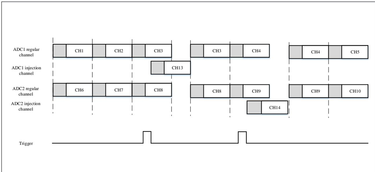
如果在注入转换期间产生了另一个注入触发，这个触发将被忽略。如下图所示
