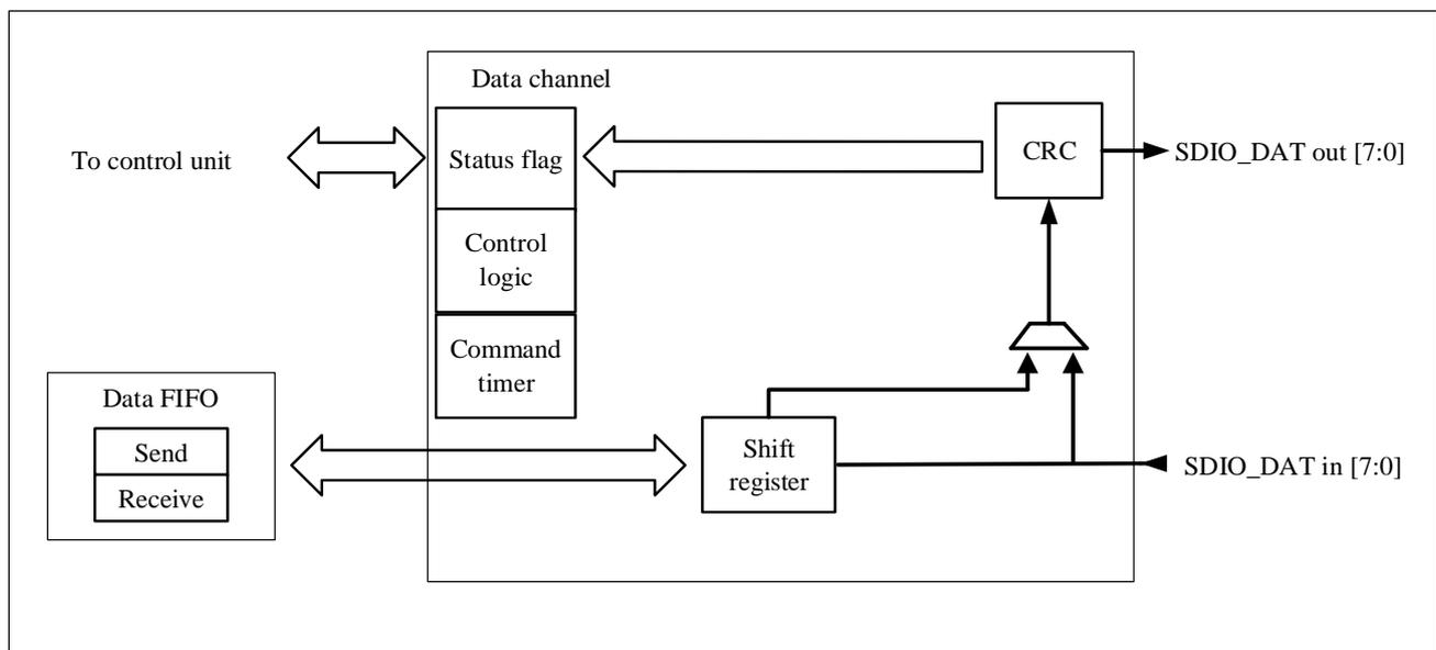
在时钟控制寄存器（SDIO\_CLKCTRL）中可以配置卡的数据总线宽度。当数据宽度为 4 位（SDIO\_CLKCTRL.BUSMODE 位为 0b01）时，每个时钟周期 SDIO\_DAT[3:0] 四条数据信号线上将传输 4 位数据；当数据宽度为 8 位（SDIO\_CLKCTRL.BUSMODE 位为 0b10）时，则每个时钟周期 SDIO\_DAT[7:0] 八条数据信号线上将传输 8 位数据；当数据宽度为 1 位（SDIO\_CLKCTRL.BUSMODE 位为 0b00）或者没有选择总线模式时，每个时钟周期只在 SDIO\_DAT0 上传输 1 位数据。
