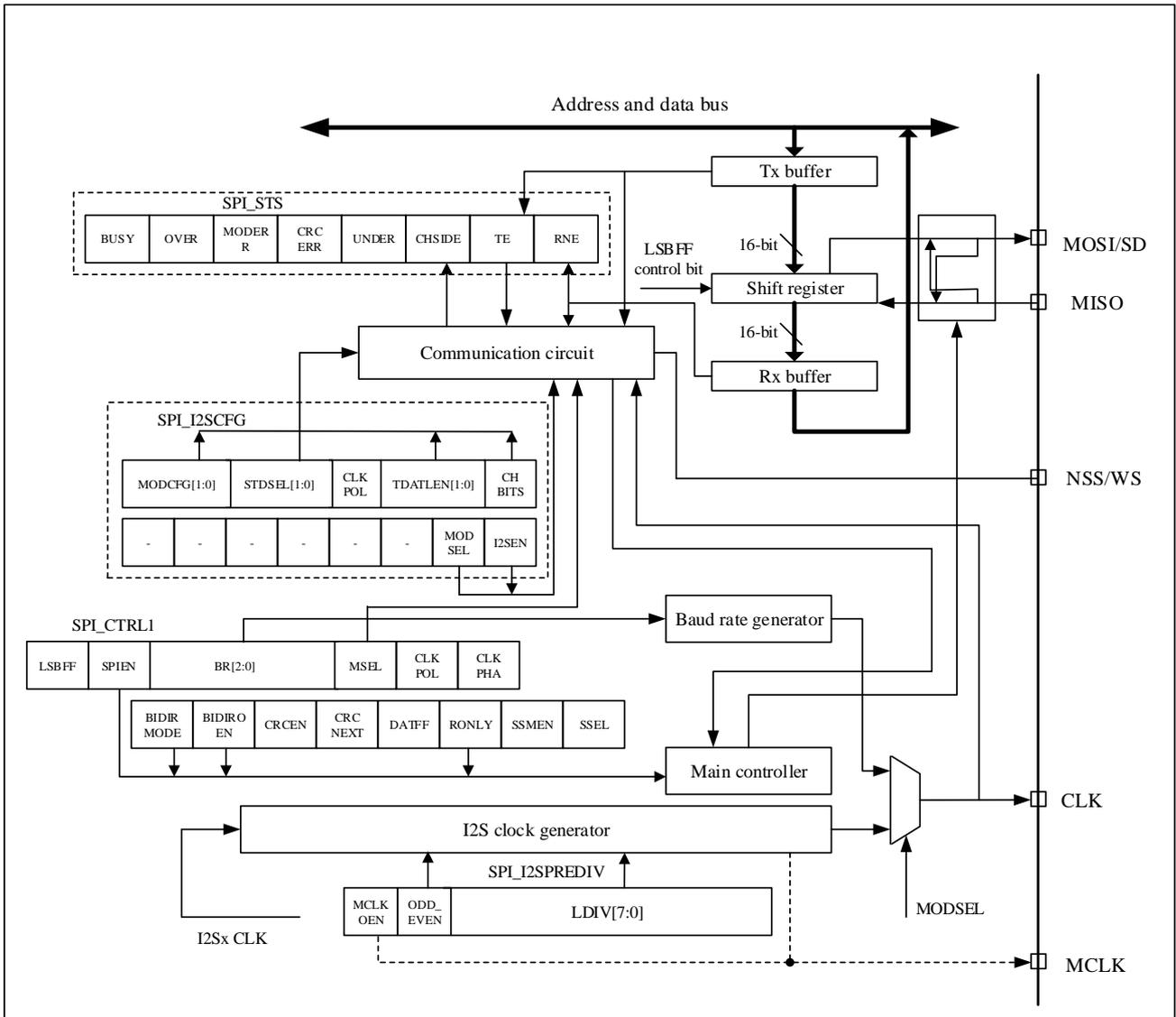
I<sup>2</sup>S 接口使用和 SPI 接口相同的引脚、标志和中断。SPI\_I2SCFG.MODSEL 位置 1 选择 I<sup>2</sup>S 音频接口。
