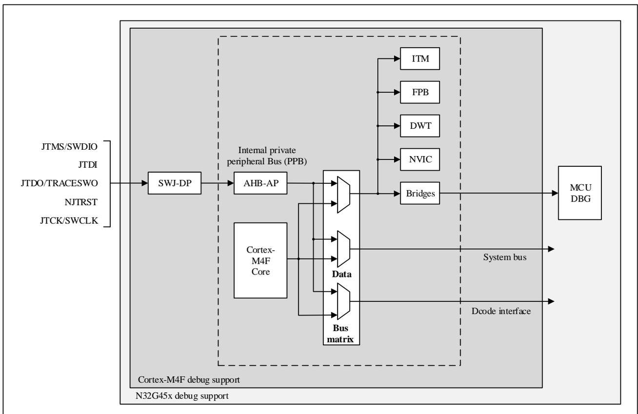
ARM Cortex™-M4F 内核硬件调试模块可提供如下调试功能：
