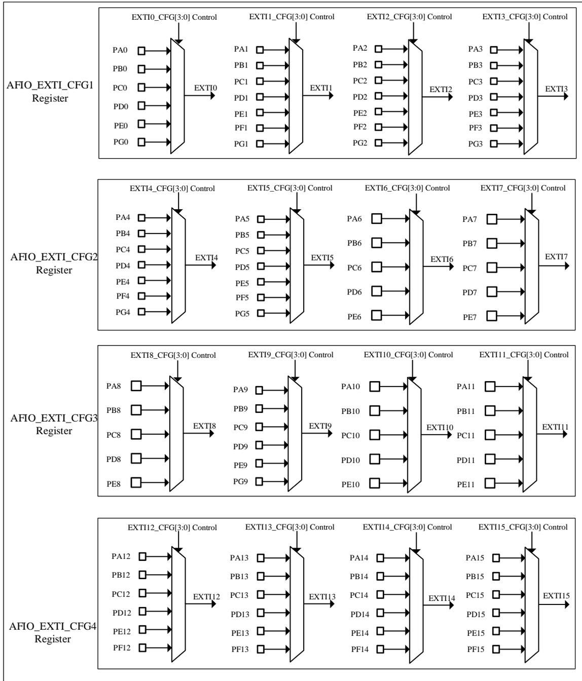
通过 AFIO\_EXTI\_CFGy 配置 GPIO 线上的外部中断/事件，必须先使能 AFIO 时钟。通用 I/O 端口以上图的方式连接到 16 条外部中断/事件线上。另外 5 条 EXTI 线的连接方式如下：
