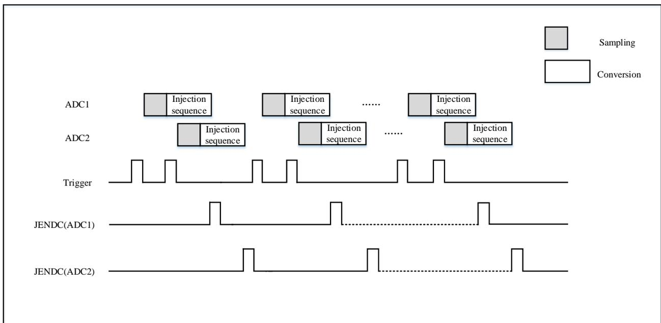
如果 ADC1 和 ADC2 上同时使用了注入间断模式，当第一次触发产生，ADC1 的第一组注入通道被转换，
