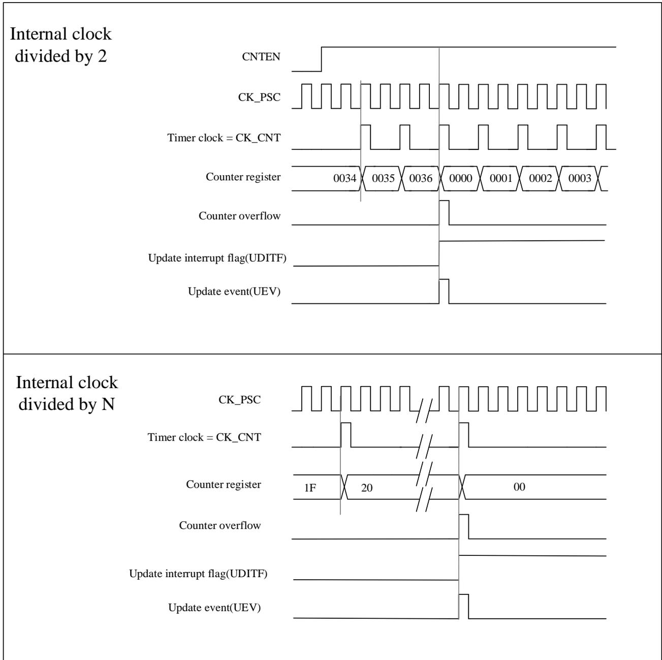
图 11-4 当 ARPEN=0/1 产生更新事件时，向上计数的时序图
