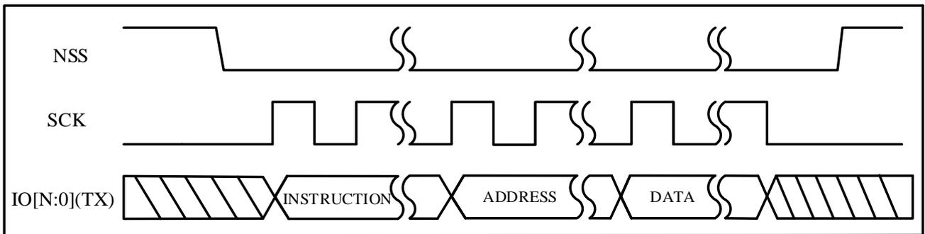
QSPI\_ENH\_CTRL0.TRANS\_TYPE[1:0]须配置为 0x02。QSPI\_CTRL0.SPI\_FRF[1:0]配置为 0x02（四线模式）时，N=3；QSPI\_CTRL0.SPI\_FRF[1:0]配置为 0x01（双线模式）时，N=1。
