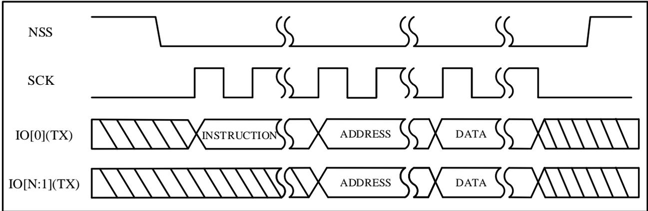
QSPI\_ENH\_CTRL0.TRANS\_TYPE[1:0]须配置为 0x01。QSPI\_CTRL0.SPI\_FRF[1:0]配置为 0x02（四线模式）时，N=3；QSPI\_CTRL0.SPI\_FRF[1:0]配置为 0x01（双线模式）时，N=1。
