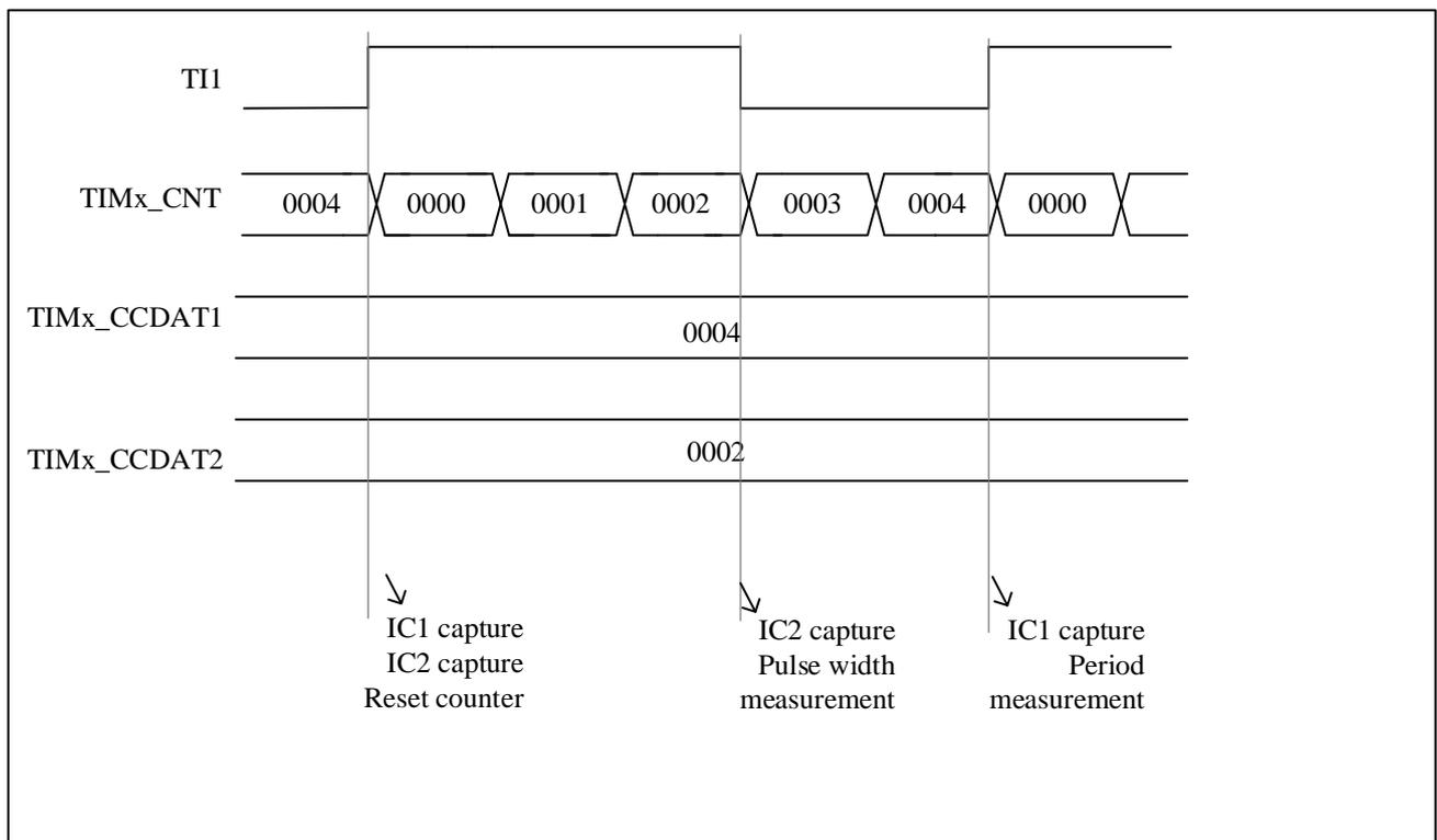
由于只有滤波器定时器输入 1 (TI1FP1) 和滤波器定时器输入 2 (TI2FP2) 连接到从模式控制器, 因此 PWM 输入模式只能与 TIMx\_CH1/TIMx\_CH2 信号一起使用。
