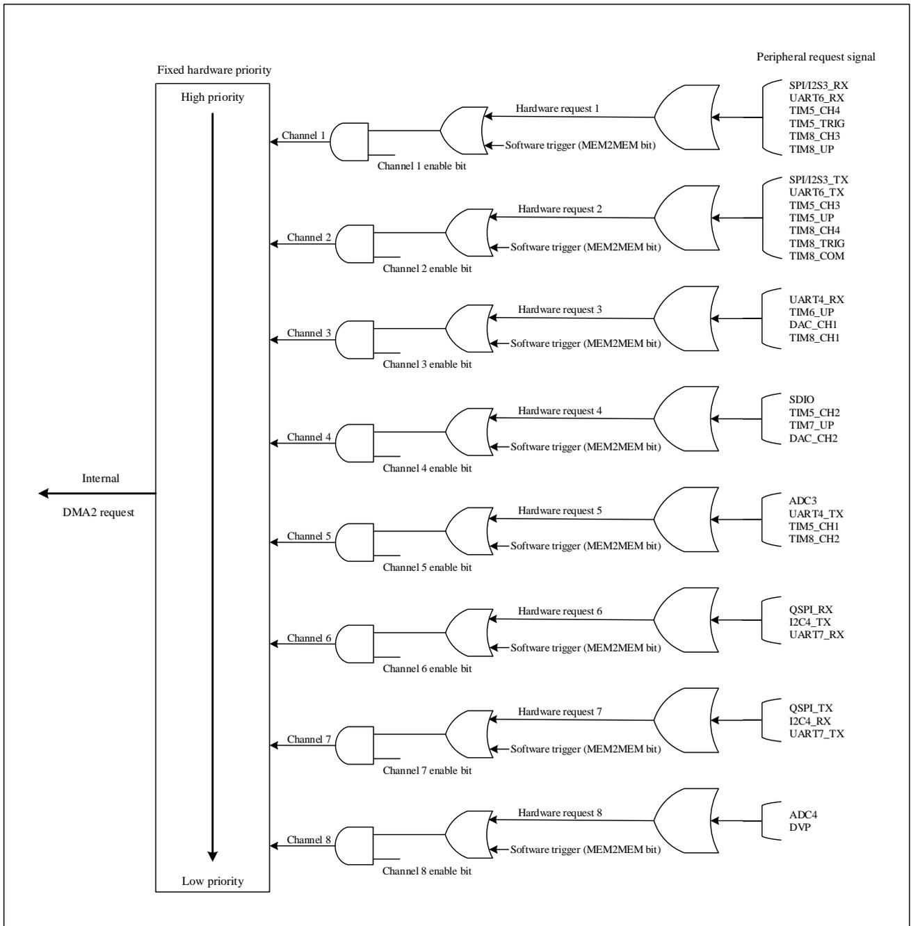
表 8-5 各个通道的 DMA2 请求映射表
