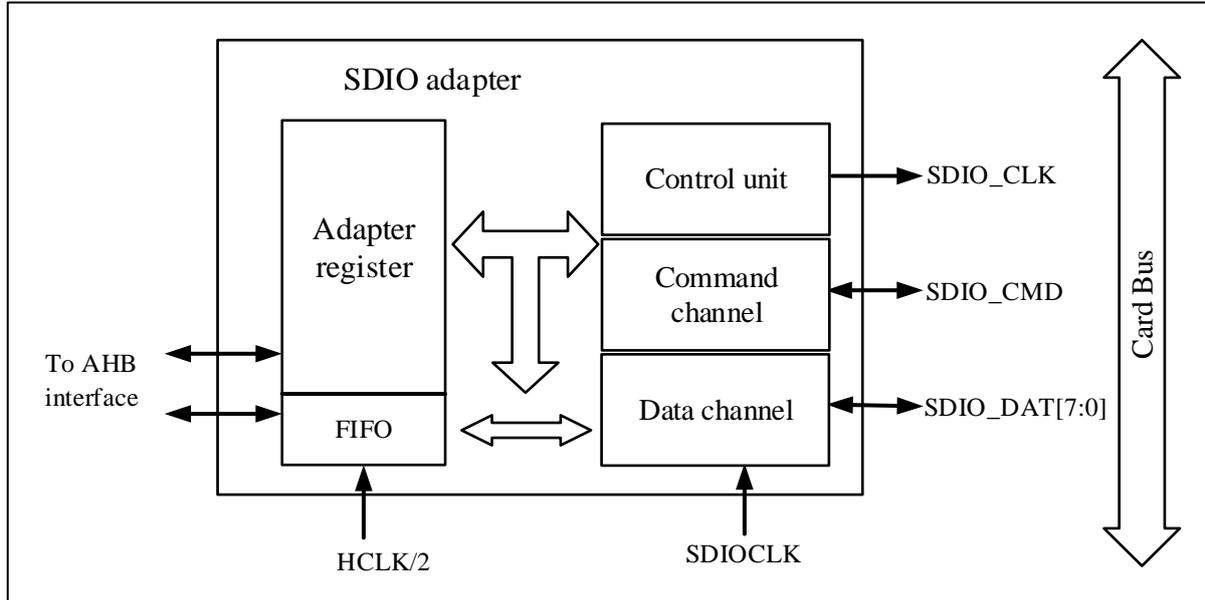
AHB 总线的 HCLK/2 作为适配器寄存器和 FIFO 的时钟，SDIOCLK（等于 HCLK）作为控制单元、命令通道和数据通道的时钟。
