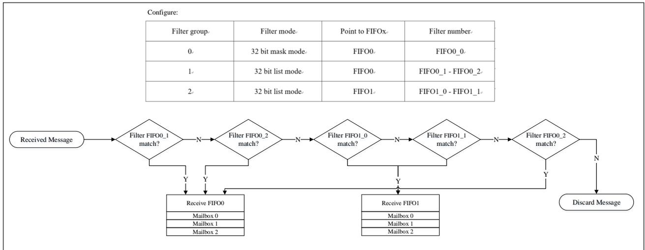
图 20-10 说明了 CAN 的过滤规则。收到消息时，首先将其标识符与标识符列表模式中配置的过滤器进行比较。如果匹配，则将消息存储在关联的 FIFO 中，并将匹配过滤器的序列号存储在过滤器匹配序列号中。如果不匹配，则将消息标识符与掩码模式中配置的过滤器进行比较。如果消息标识符与过滤器中的任何标识符不匹配，硬件将自动丢弃该消息而无需软件干预。
