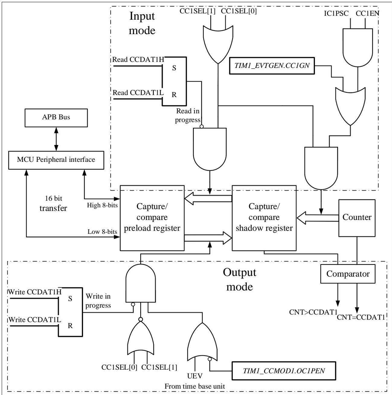
图 12-15 通道 x 的输出部分（以通道 4 为例子）
