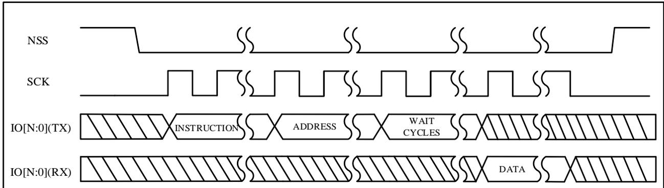
QSPI\_ENH\_CTRL0.TRANS\_TYPE[1:0]配置应为 0x2。QSPI\_CTRL0.SPI\_FRF[1:0]配置为 0x02（四线模式）时，N=3；QSPI\_CTRL0.SPI\_FRF[1:0]配置为 0x01（双线模式）时，N=1。
