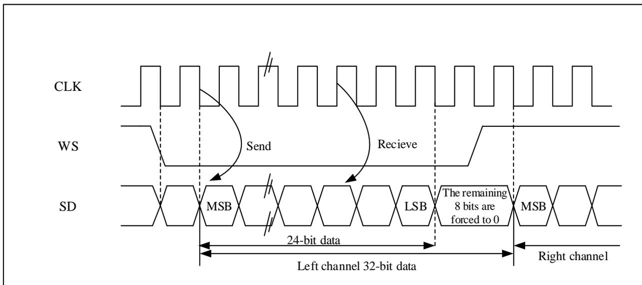
如果 24 位数据需要打包成 32 位数据帧格式，每帧数据传输时，CPU 需要读或写 SPI\_DAT 寄存器 2 次。例如，如果用户发送 24 位数据 0x95AA66，CPU 将首先写 0x95AA 进 SPI\_DAT 寄存器，然后再写 0x66XX 进 SPI\_DAT 寄存器（仅高 8 位数据有效，低 8 位数据是无意义的，可以是任何值）；如果用户接收 24 位数据 0x95AA66，CPU 将首先读 SPI\_DAT 寄存器得到 0x95AA，然后再读 SPI\_DAT 寄存器得到 0x6600（仅高 8 位数据有效，低 8 位数据总是 0）。
