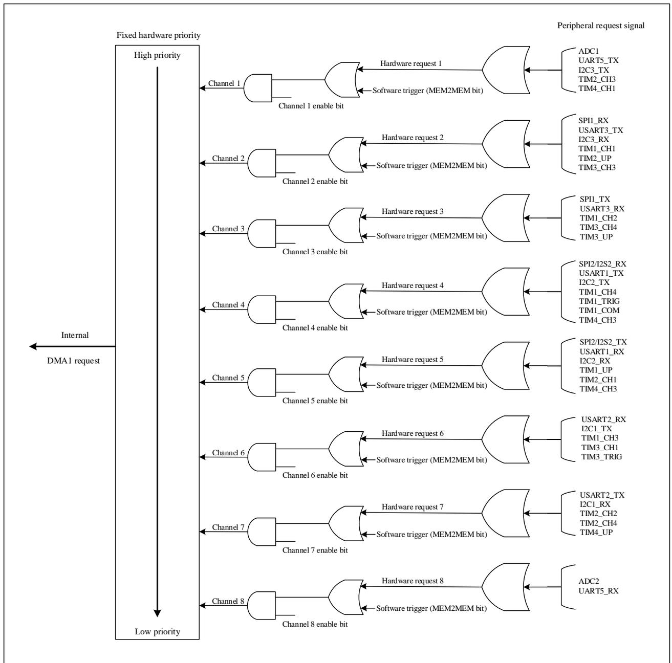
**表 8-4 各个通道的 DMA1 请求映射表**
