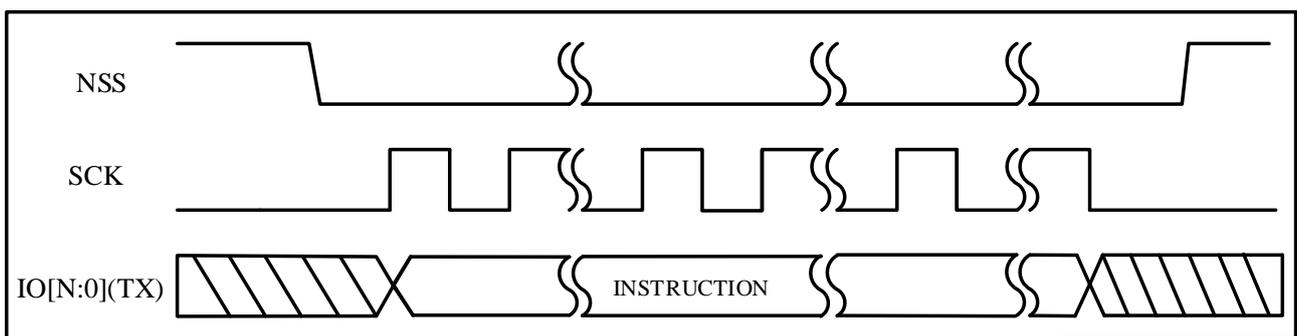
和 QSPI\_ENH\_CTRL0.TRANS\_TYPE[1:0]配置无关。QSPI\_CTRL0.SPI\_FRF[1:0]配置为 0x02（四线模式）时，N=3；QSPI\_CTRL0.SPI\_FRF[1:0]配置为 0x01（双线模式）时，N=1。
