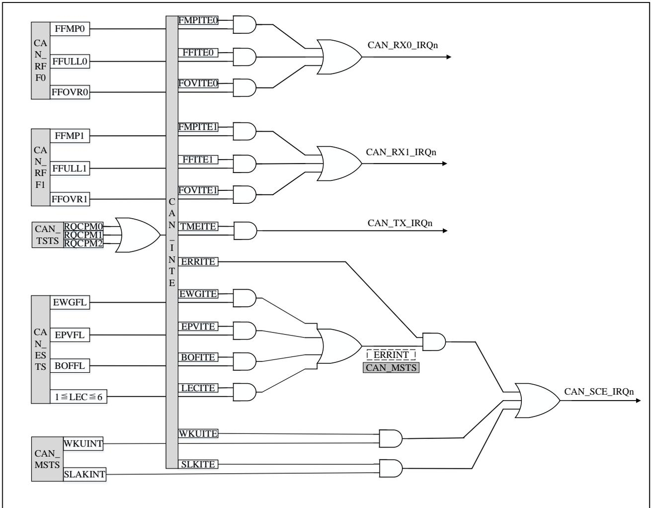
CAN 有四个中断向量。通过设置 CAN 中断启用寄存器 (CAN\_INTE)，您可以单独启用或禁用每个中断源。以下是可以产生每个中断的事件。
