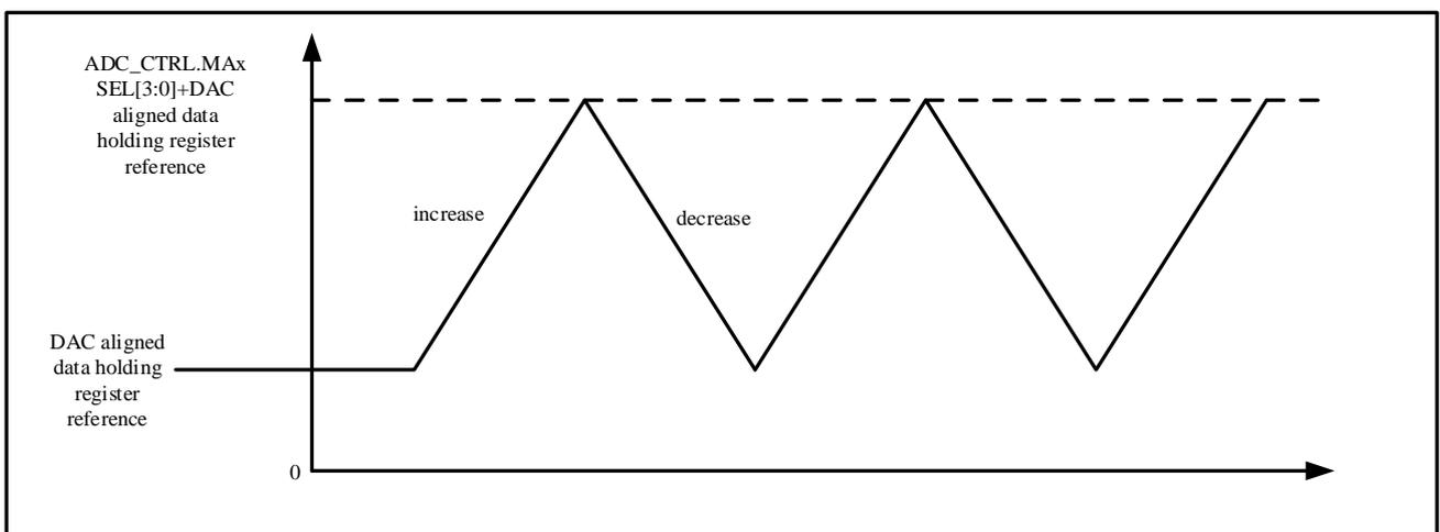
**图 10-8 带三角生成的 DAC 转换（使能软件触发）**
