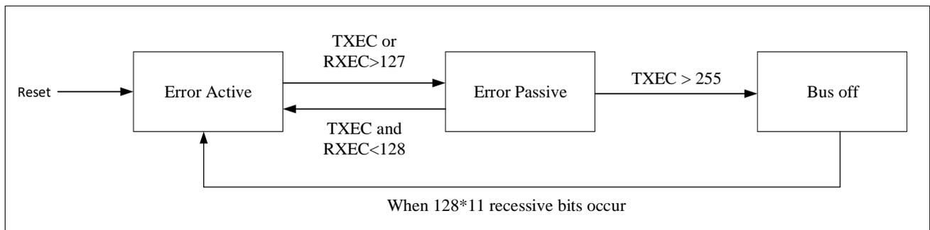
软件可以读取发送/接收错误计数器的值来判断 CAN 网络的稳定性，读取 CAN\_ESTS.LEC[2:0]位可以得到当前错误状态的详细信息。更重要的是，通过设置 CAN\_INTE 寄存器 (如 CAN\_INTE.LECITE 位)，软件可以灵活控制检测到错误时中断的产生。
