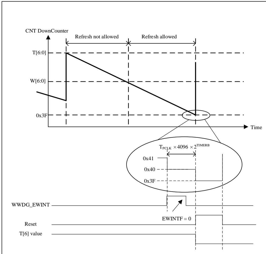
看门狗刷新窗口在WWDG\_CFG.W[6:0]值（最大值0x7F）和0x3F之间，在此窗口外刷新将向MCU生成复位请求。计数器使用分频后的APB1时钟从0x7F向下计数到0x3F，最大计数时间和最小计数时间如表17-1所示（假设APB1时钟为36MHz），计算公式为：
