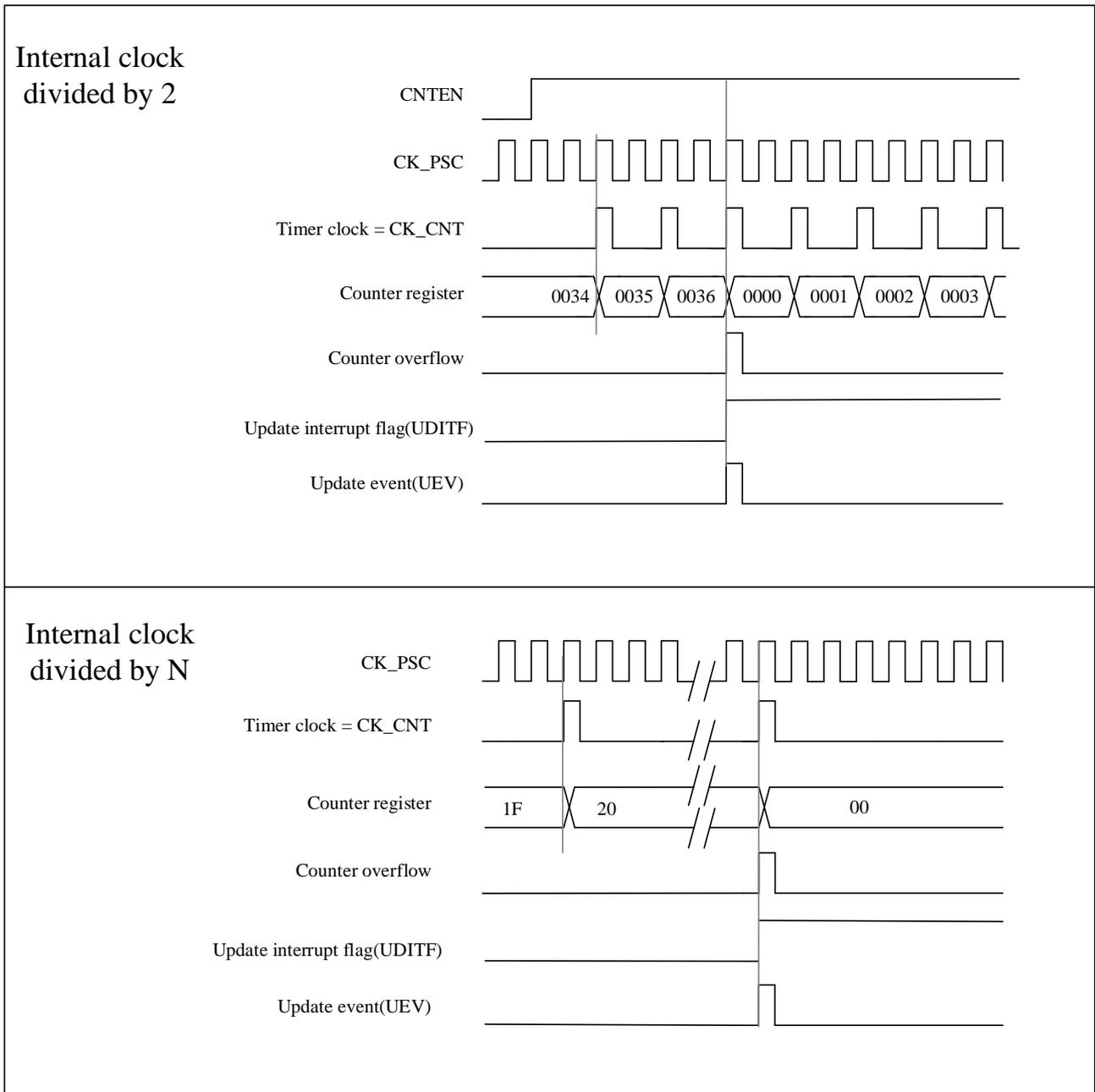
图 12-4 当 ARPEN=0/1 产生更新事件时，向上计数的时序图
