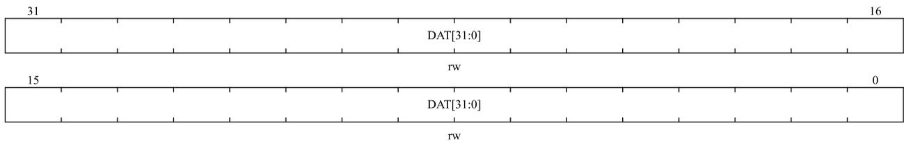
该寄存器实质上是指向 8 个不透明的唤醒帧过滤器寄存器的指针 (使用同一个偏移地址)。对该寄存器地址 (偏移为 0x0028) 的 8 次连续写操作，可以写入全部 8 个唤醒帧过滤器寄存器；对该寄存器地址 (偏移为 0x0028) 的 8 次连续读操作，可以读出全部 8 个唤醒帧过滤器寄存器。参考表 25-7 远程唤醒帧过滤器寄存器总览。
