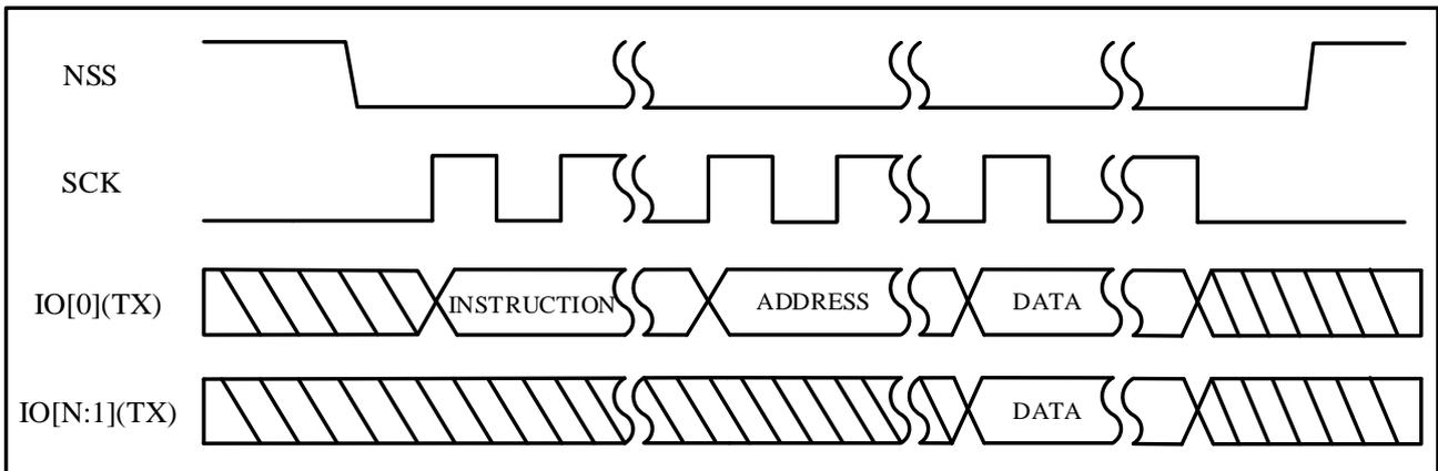
QSPI\_ENH\_CTRL0.TRANS\_TYPE[1:0]须配置为 0。QSPI\_CTRL0.SPI\_FRF[1:0]配置为 0x02 (四线模式) 时,  $N=3$ ; QSPI\_CTRL0.SPI\_FRF[1:0]配置为 0x01 (双线模式) 时,  $N=1$ 。
