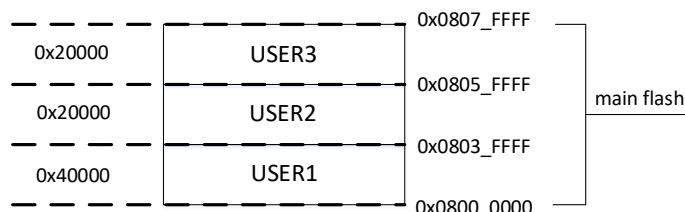
图 4-1 Flash 主存储区区域划分关系示例
