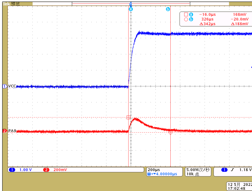
图 1-5 上电过程 IO(PA9)波形
