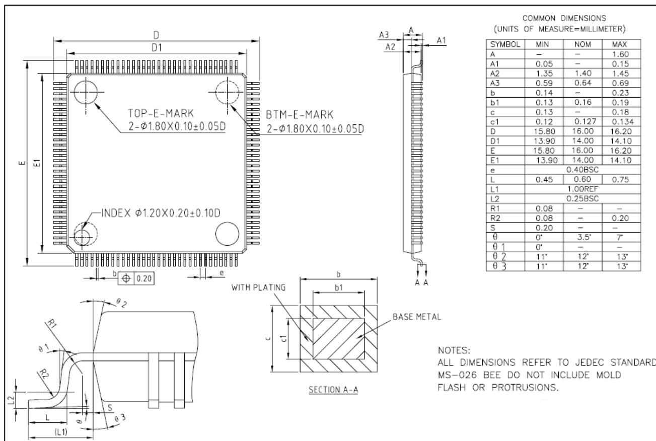
图 5-10 LQFP128封装焊盘建议<sup>(1)</sup>
