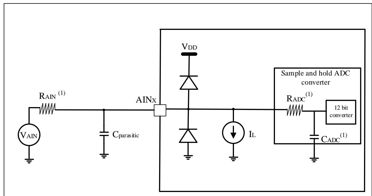
1. 有关 $R_{AIN}$ 、 $R_{ADC}$ 和 $C_{ADC}$ 的数值，参见表 4-44。
