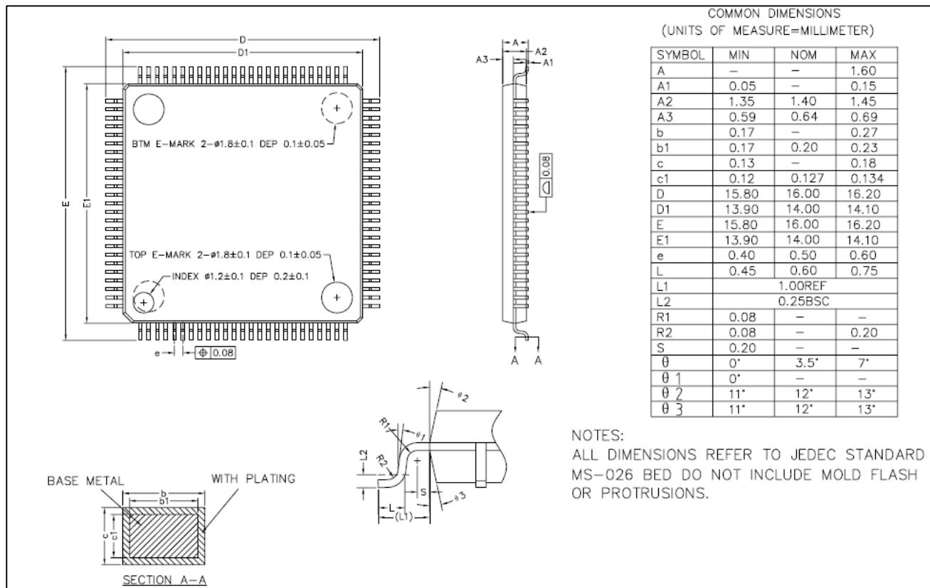
图 5-8 LQFP100封装焊盘建议<sup>(1)</sup>
