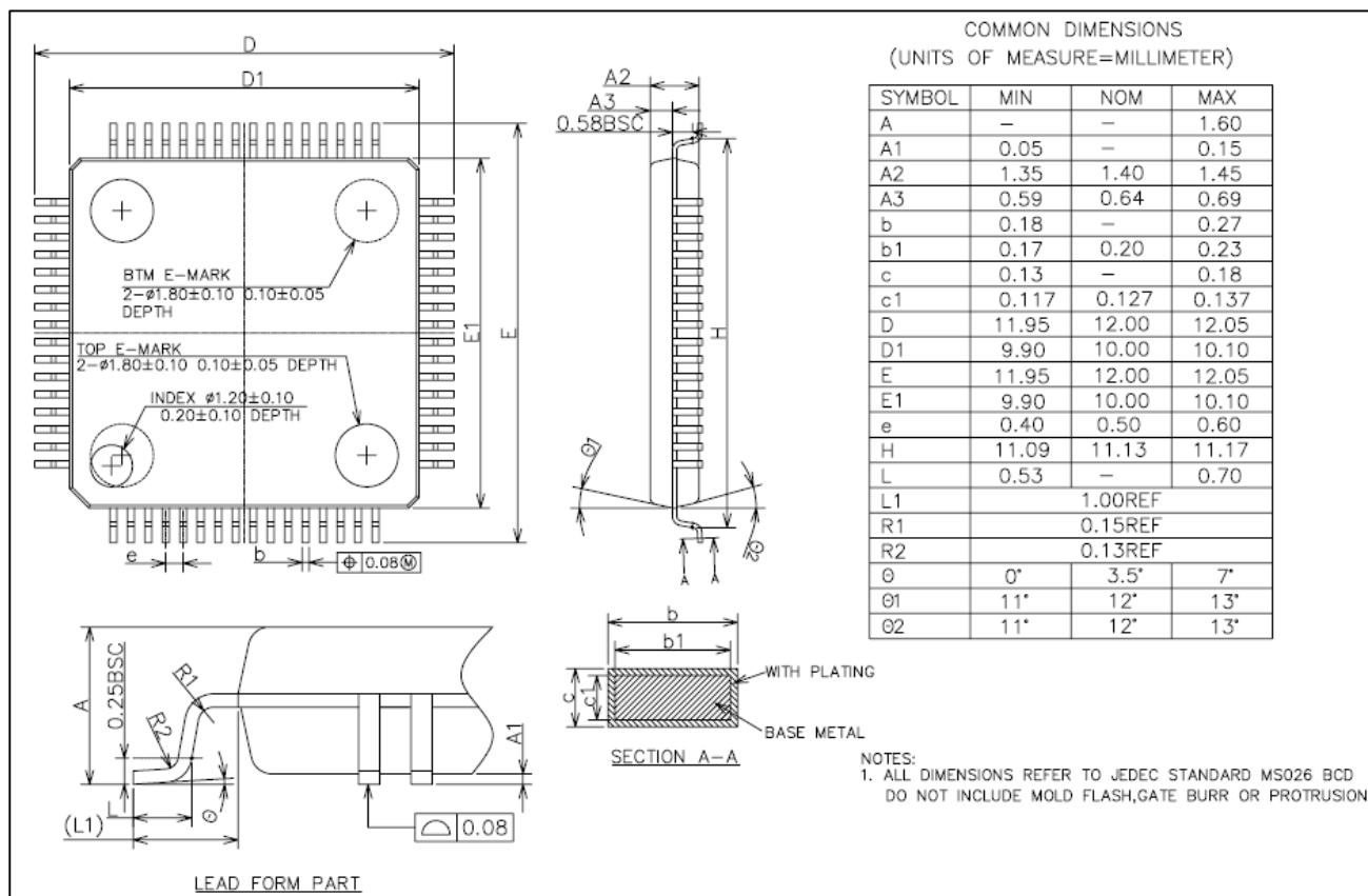
图 5-4 LQFP64封装焊盘建议<sup>(1)</sup>
