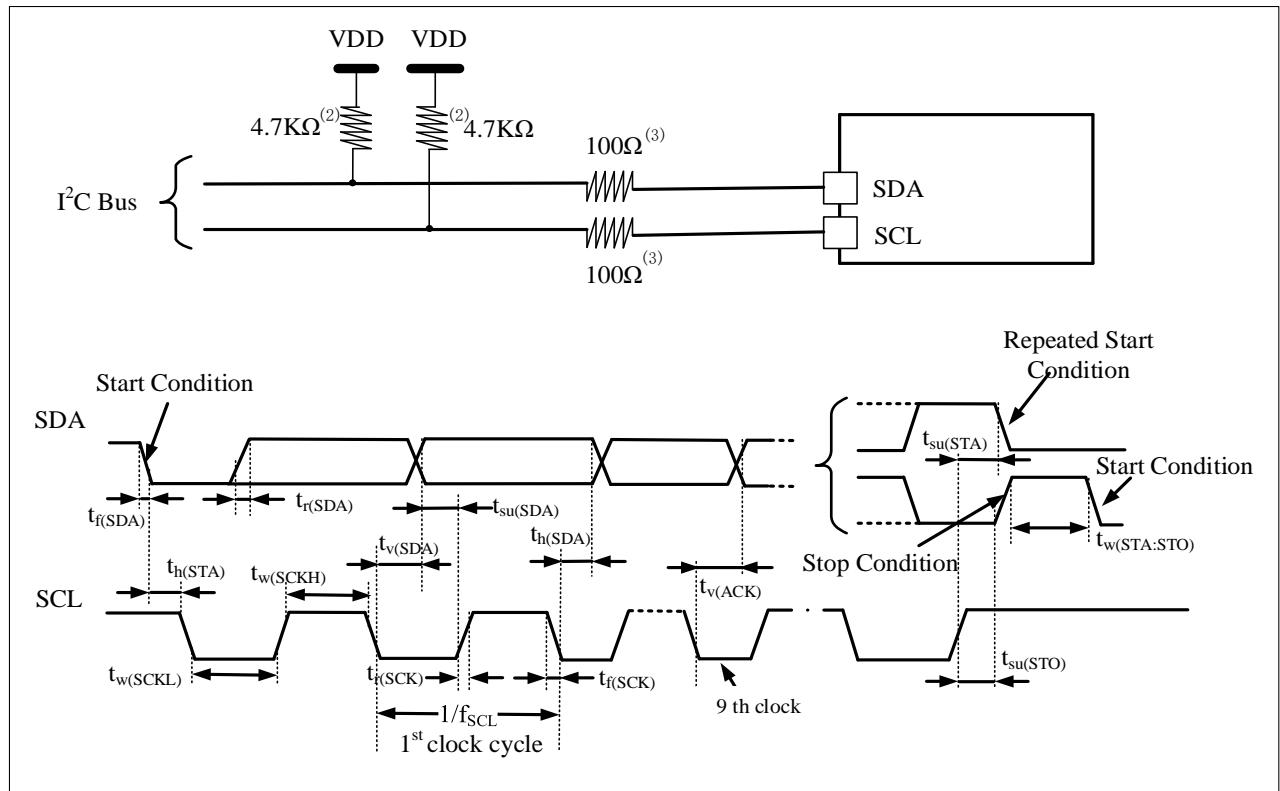
1. 测量点设置于CMOS电平: 0.3V<sub>DD</sub>和0.7V<sub>DD</sub>。
