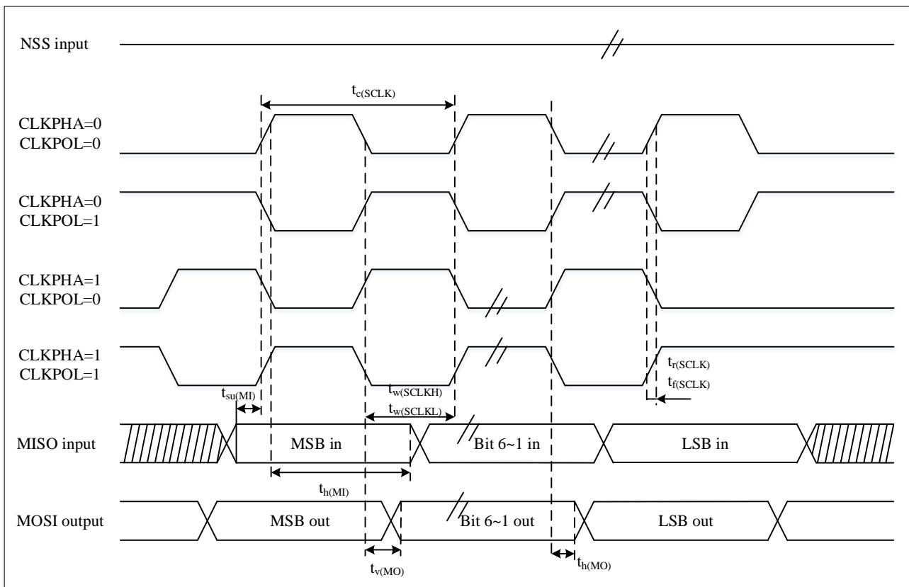
1. 测量点设置于 $0.3V_{DD}$ 和 $0.7V_{DD}$ 。
