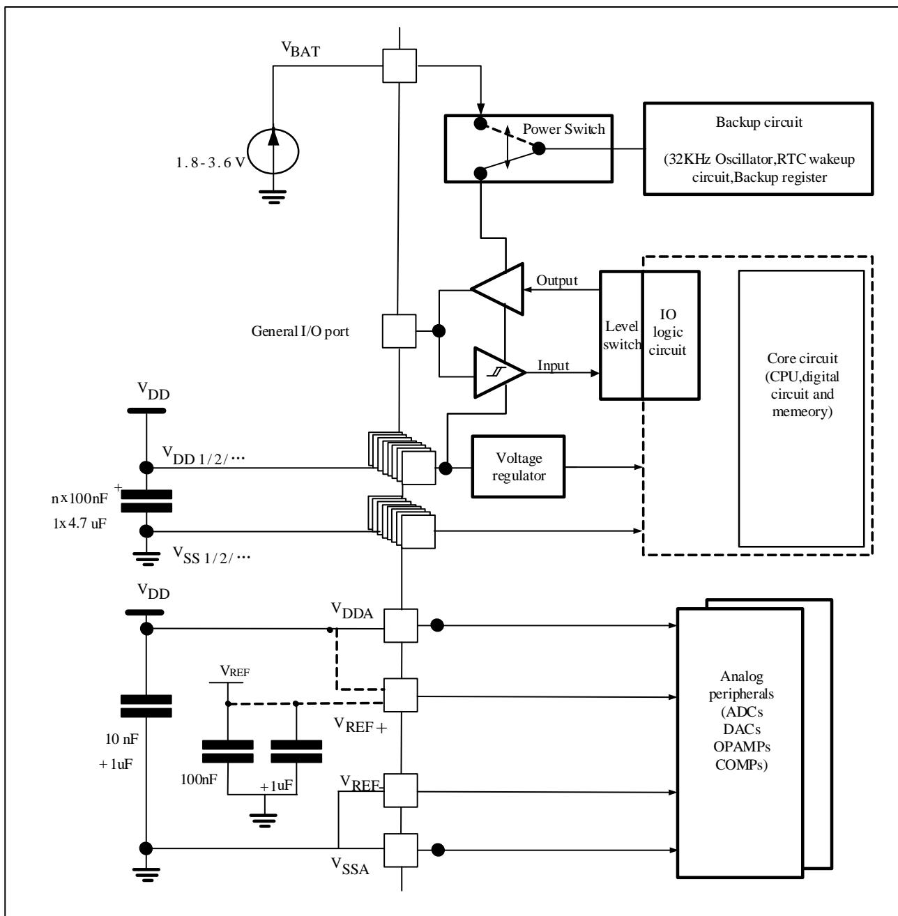
注：上图中的 $4.7\mu F$ 电容必须连接到 $V_{DD3}$ 。
