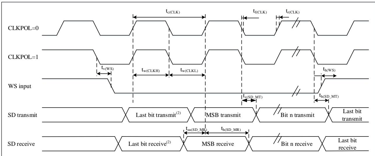
1. 测量点设置于0.3V<sub>DD</sub>和0.7V<sub>DD</sub>。
