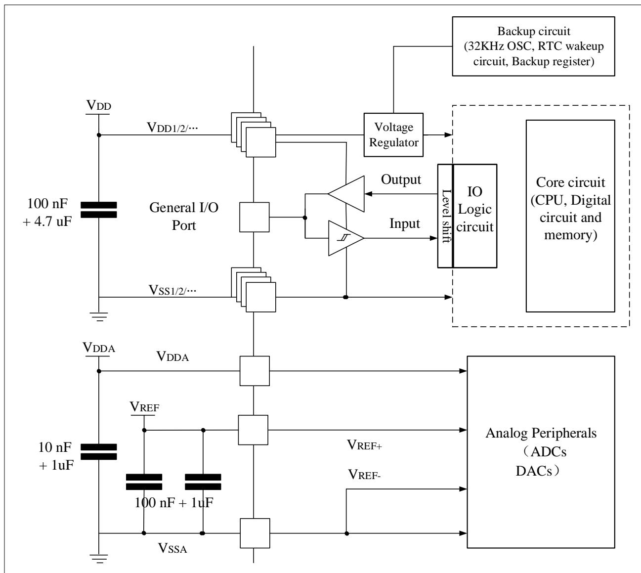
注意：电容连接方式请参考硬件设计指南。VREF 只供给ADC和DAC。
