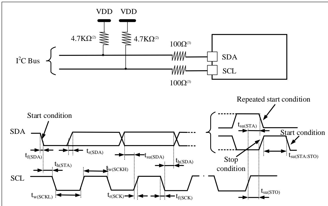
1. 测量点设置在CMOS电平: 0.3V<sub>DD</sub>和0.7V<sub>DD</sub>。
