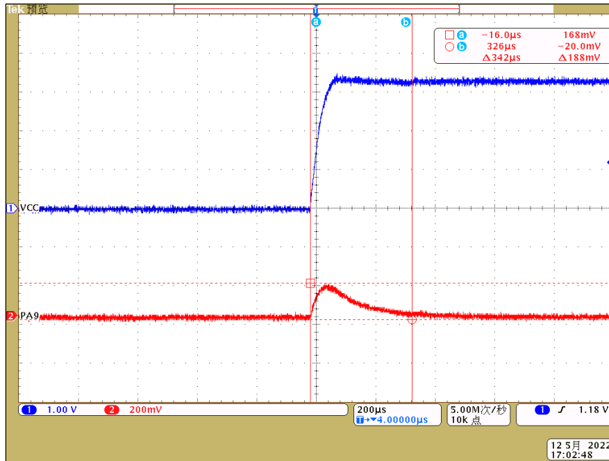
图 1-6 上电过程 IO(PA9)波形
