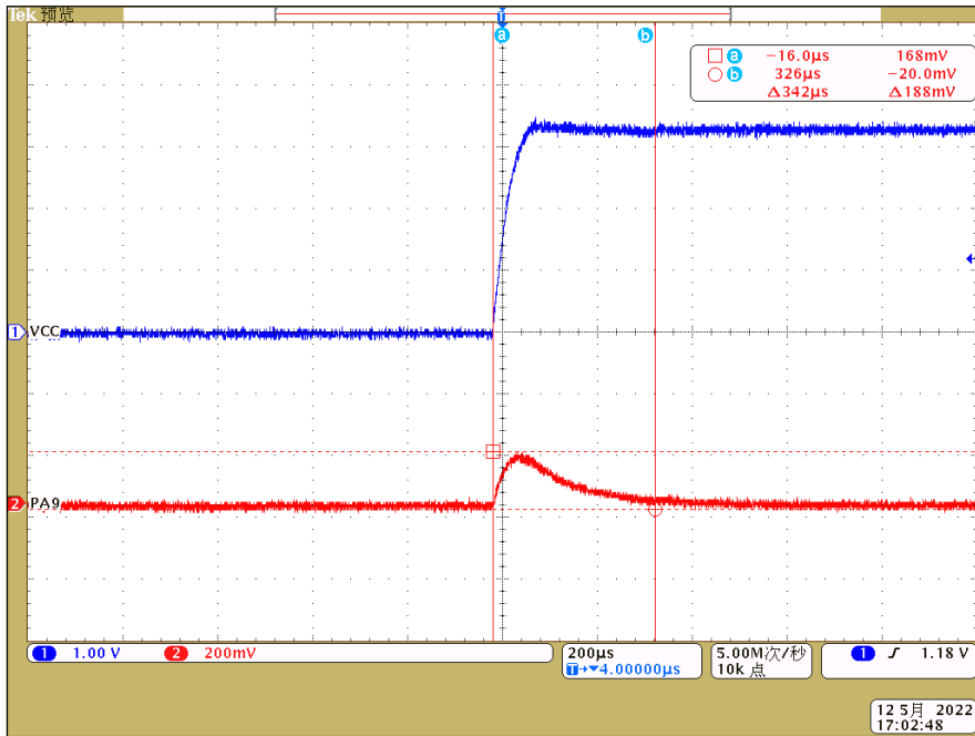
图 1-4 上电过程 IO(PA9)波形
